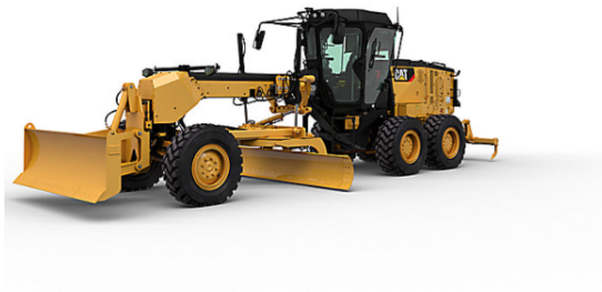
Figura A.8: Motoniveladora. Fuente: Caterpillar
