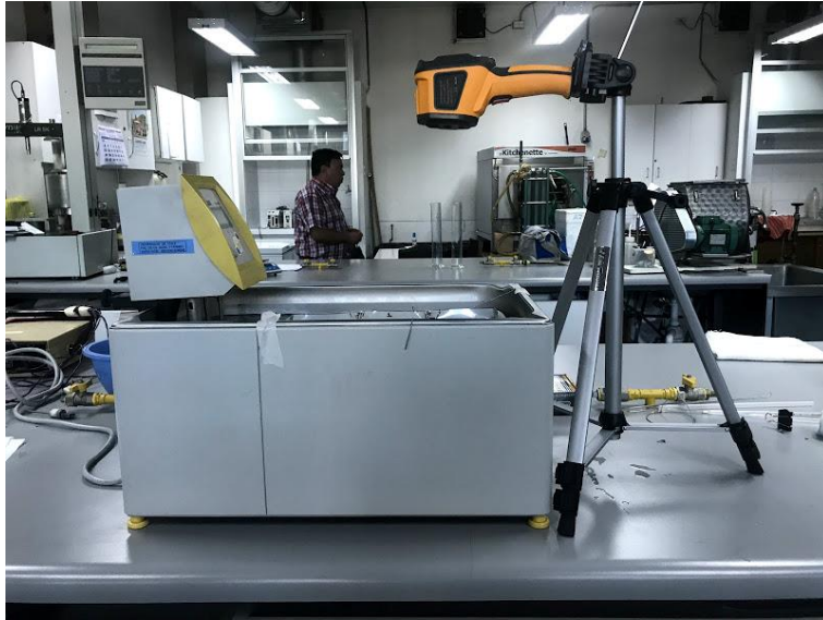
Figura 21: Imagen del equipo de Ventana de Refractividad a escala de laboratorio con la cámara infrarroja instalada
