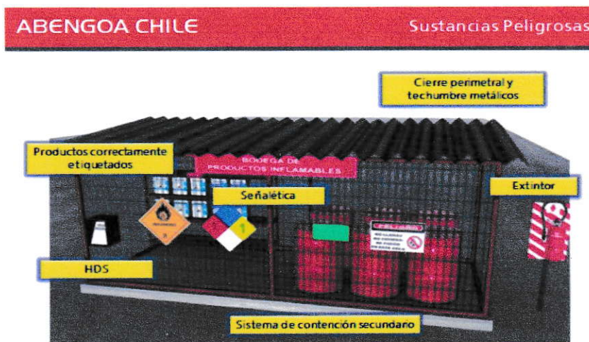
Figura 1: Tipo de bodega de Residuos Industriales Peligrosos.
