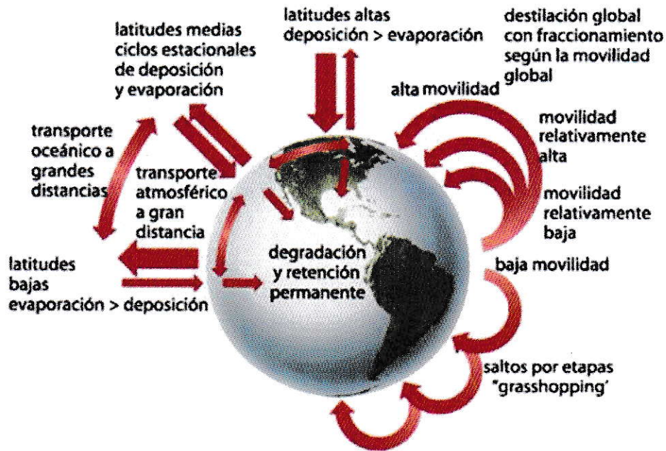
Figura 5. Movilidad de los COPs a diferentes latitudes. La deposición de los contaminantes se manifiesta más que la evaporación, en zonas de mayor latitud y temperaturas más bajas (Wania & Mackay, 1996).
