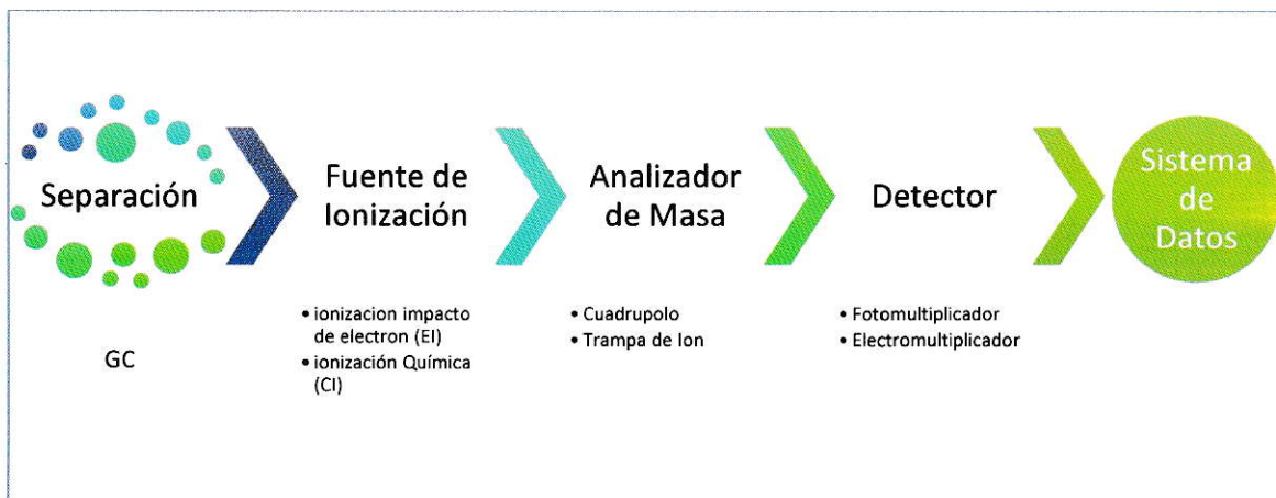
Figura 13. Etapas para la medición de masa de un analito en un detector selectivos de masa (Mattice, 2010).
