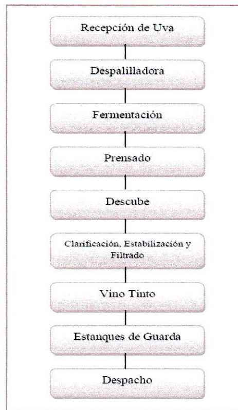
Figura 10. Diagrama producción de vino tinto Viña Corre Albano (Sebastián Astaburuaga y Cía S.A, 2006)
