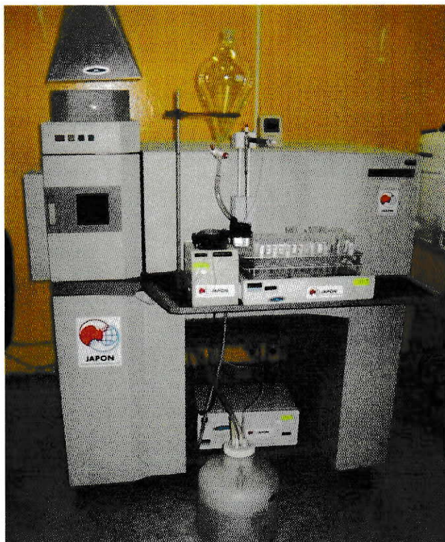
Figura 8. Equipo ICP-OES Perkin Elmer en el Laboratorio de Química Ambiental (CENMA).
