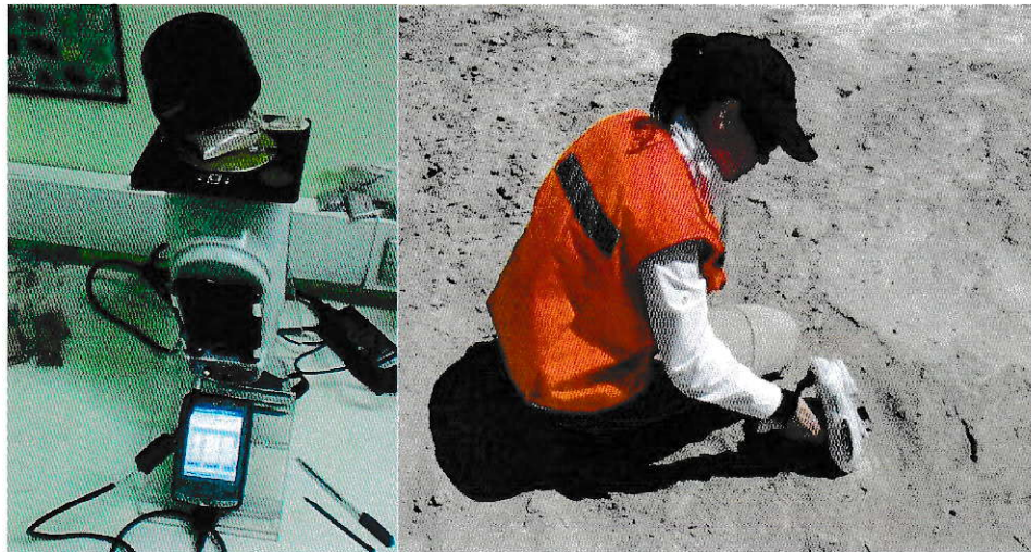
Figura 12. Análisis de muestras por XRF en el laboratorio y en terreno.
