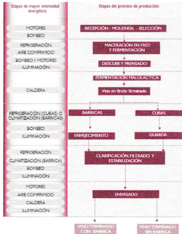
Figura 5. Equipos de consumo energético, por etapa del proceso de producción del vino tinto.
