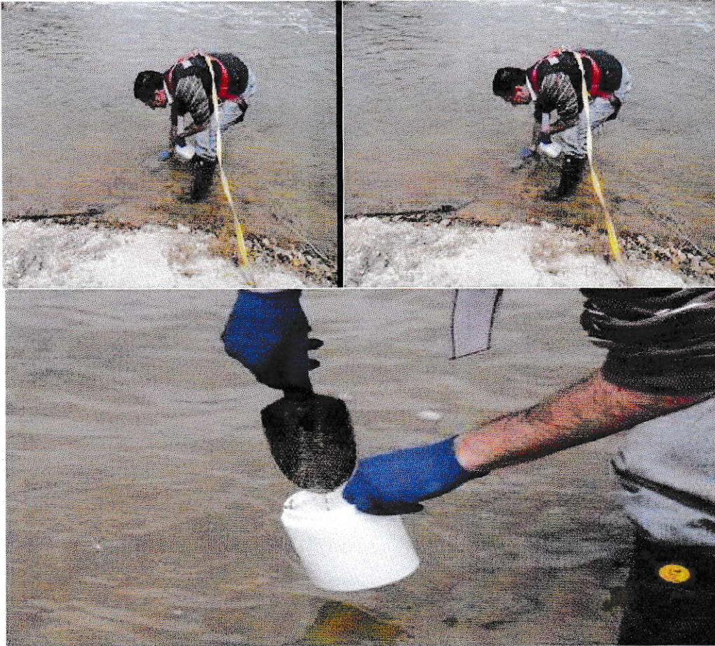
Figura 10. Toma de muestras introduciendo la pala en sentido aguas arriba de la corriente y colocando la muestra en frasco plástico de boca ancha.
