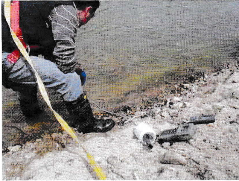
Figura 9. Condiciones del muestreo: uso de implementos de seguridad personal (botas, guantes, cuerda de vida), colocar los instrumentos para medición en terreno, pala y frasco listos para tomar la muestra de sedimento.
