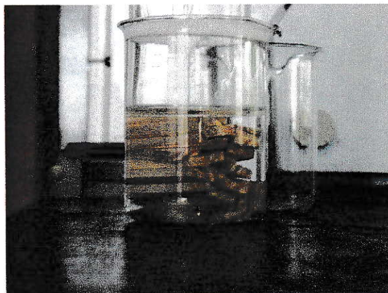
Figura 6. Inmersión de las probetas de madera en productos antimancha y lavado en agua potable.
