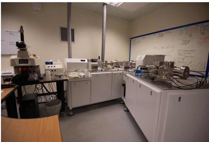
Figura 5. Espectrómetro de Masas con Plasma Acoplado Inductivamente NuPlasma HR ( MC-ICP-MS), Departamento de Ciencias de la Tierra, University of Cape Town, Sudáfrica.
