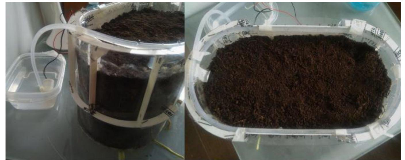
Figura 55. Imágenes del experimento 2 del sistema de riego (riego por goteo forzado). Elaboración propia.
