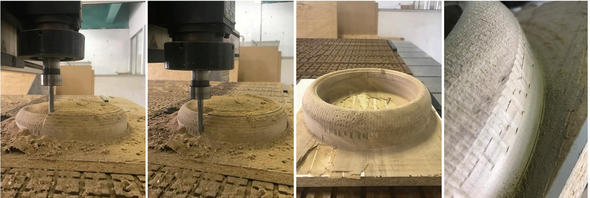
Para esta etapa, se comenzó con la construcción de la **pieza superior** del objeto (cubierta superior), el objetivo era poder entender como se comportaba el mecanizado.
