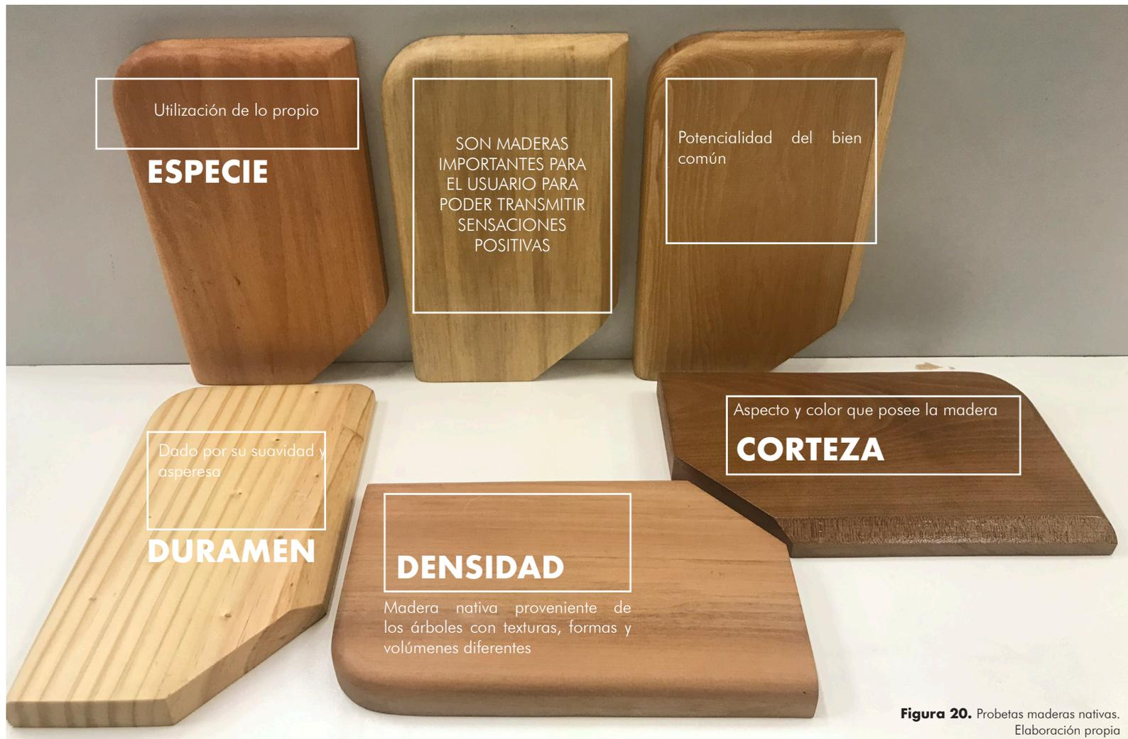
**Figura 20.** Probetas maderas nativas. Elaboración propia
