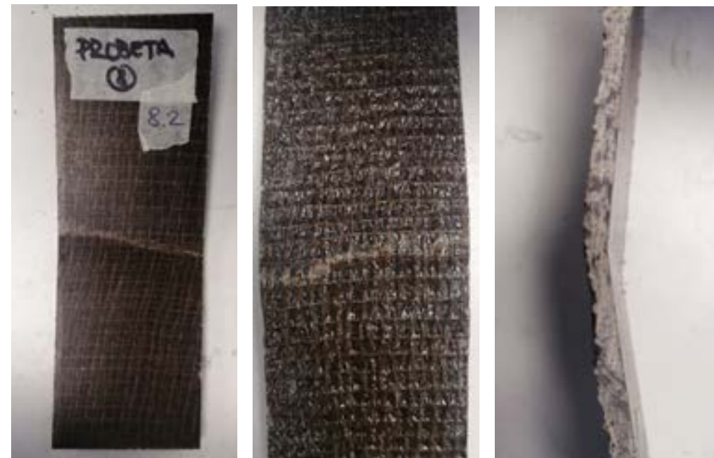
IMAGEN 3.31 Detalle rotura de probeta 8.2 post prueba de flexión. Elaboración propia, 2020.
