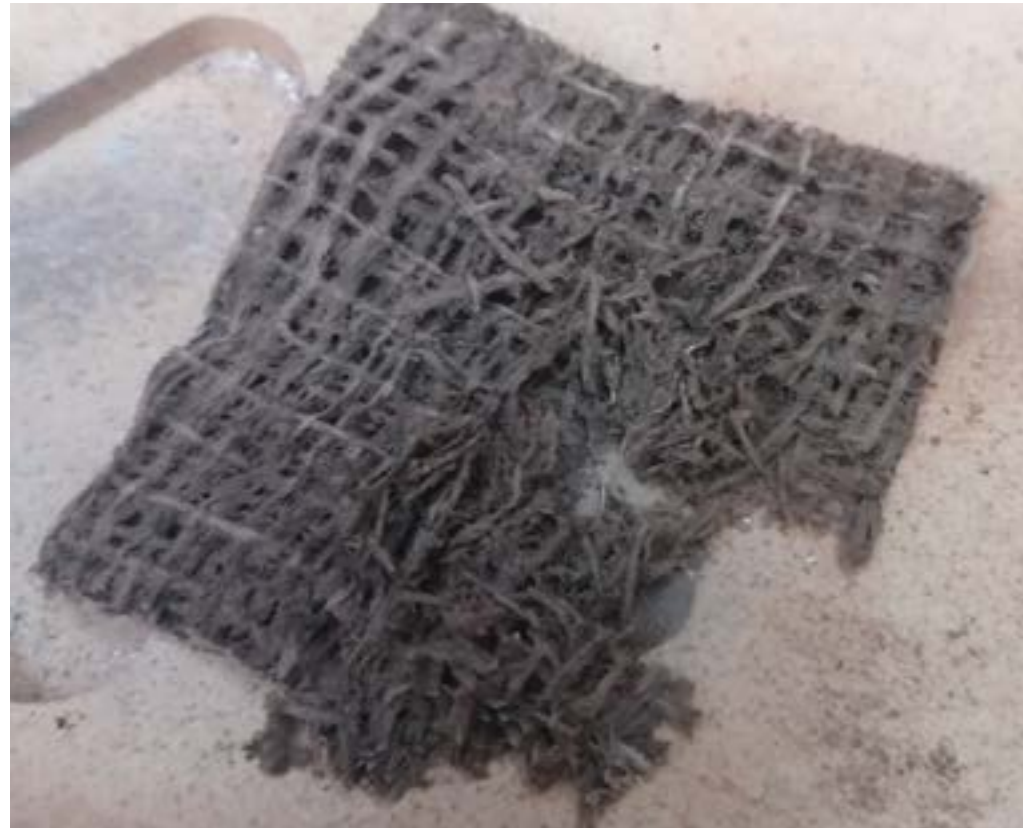
IMAGEN 3.27 Resultado probeta después de prueba de quemado. Elaboración propia, 2020.
