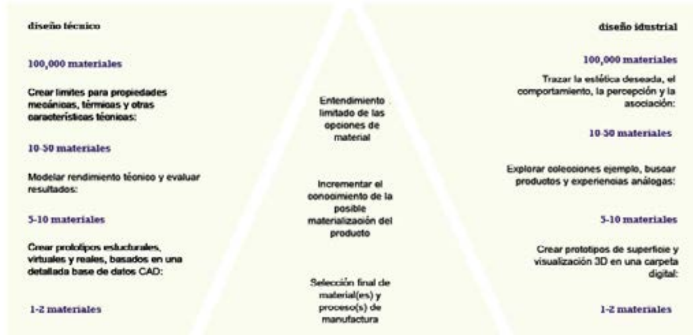
ESQUEMA 2.2 Proceso de selección de materiales. Fuente: Materials and Design, the art and science of material selection in product design, M. Ashby, K. Johnson, 2014.
