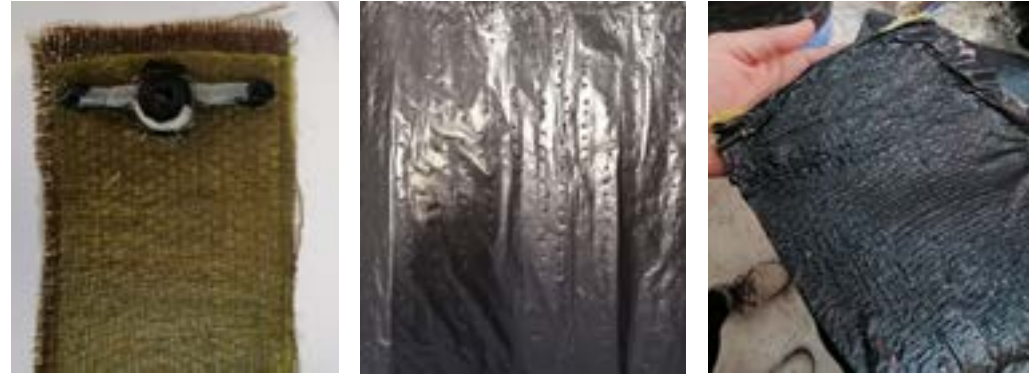
De izquierda a derecha: IMAGEN 3.17 Pieza Familia 4 con malla difusora y punto de inyección adherida por no uso de tela ni PEBD. Elaboración propia, 2020.
