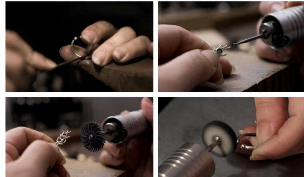
Figura 50: Procesos de desbaste, lijado y pulido. Elaboración propia.
