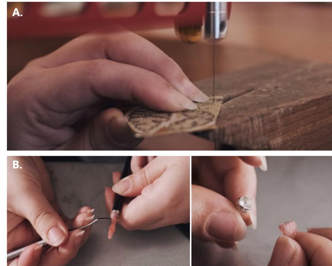
Figura 44: A. Proceso de calado en lámina de metal. B. Modelado de cera para crear copas de Liquen Cladonia. Elaboración propia.
