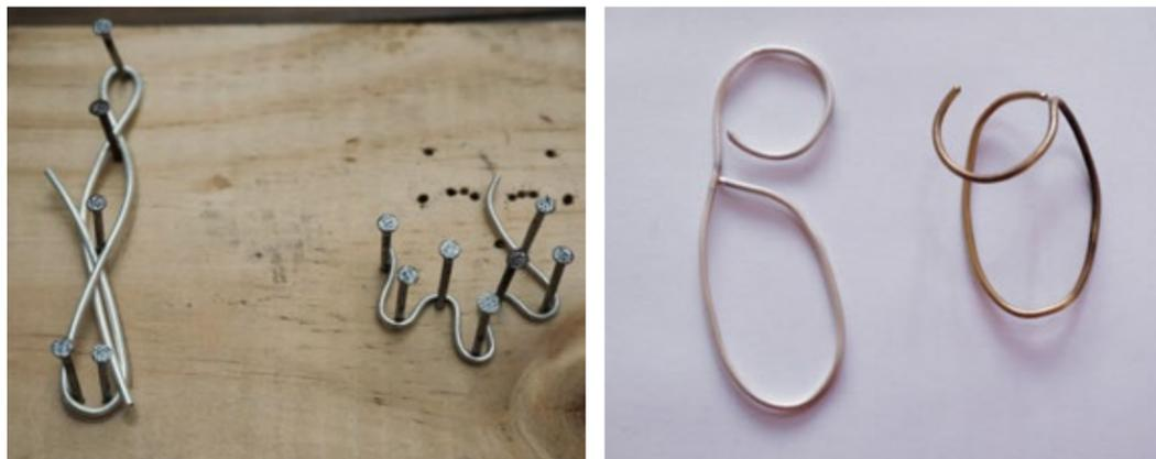
Figura 43: Curvado de alambres utilizando jigs de madera. Elaboración propia.
