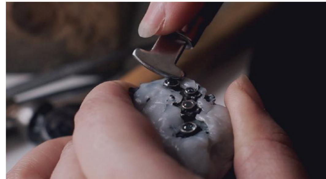
Figura 48: Engaste de caja con buril rodante para bisel. Elaboración propia.
