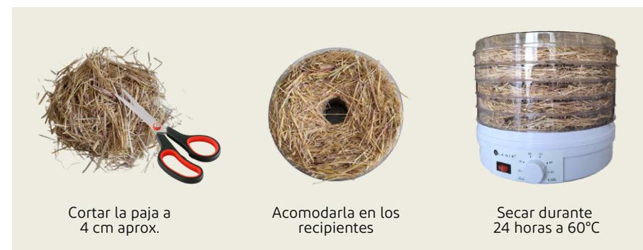
Figura 20: Proceso de secado del residuo paja de trigo. Elaboración propia.
