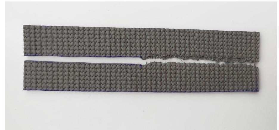
Figura 45: Muestra PVC luego del ensayo al desgarro. Elaboración propia.
