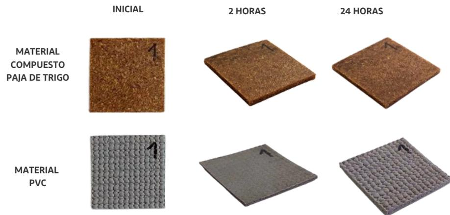
Figura 52: Muestras luego del ensayo de compresión con el bloque. Elaboración propia.
