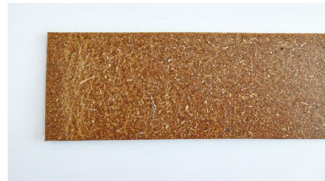
Figura 56: Marcas en la zona de enrollado de la muestra del material compuesto, ensayo memoria. Elaboración propia.
