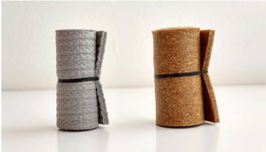
Figura 29: Muestras de PVC y material compuesto con fuerza externa en ensayo de memoria. Elaboración propia.
