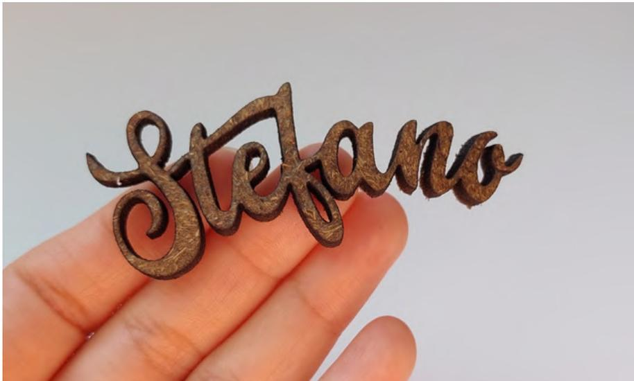
Figura 66: Resultado de corte trazo continuo. Elaboración propia.
