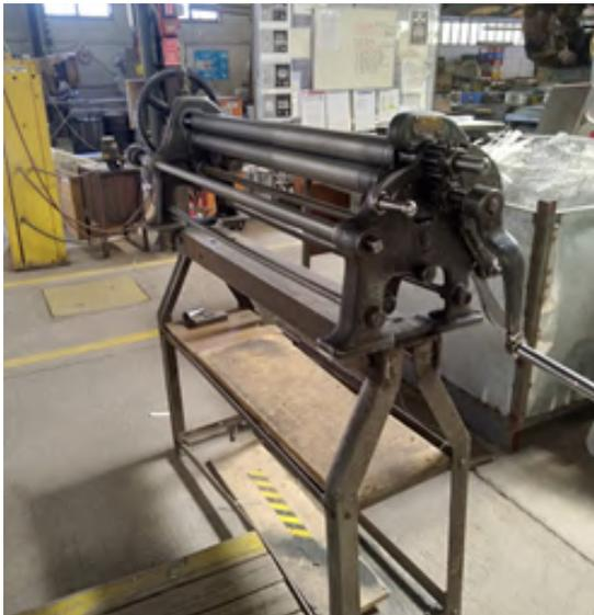
Figura 30: Cilindradora de rodillos lisos. Elaboración propia.
