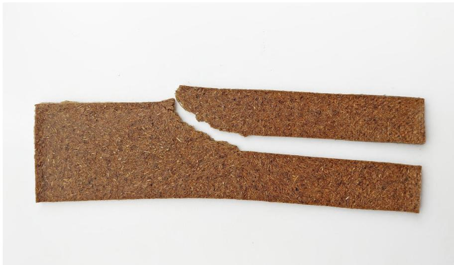
Figura 46: Muestra material compuesto luego del ensayo al desgarro. Elaboración propia.
