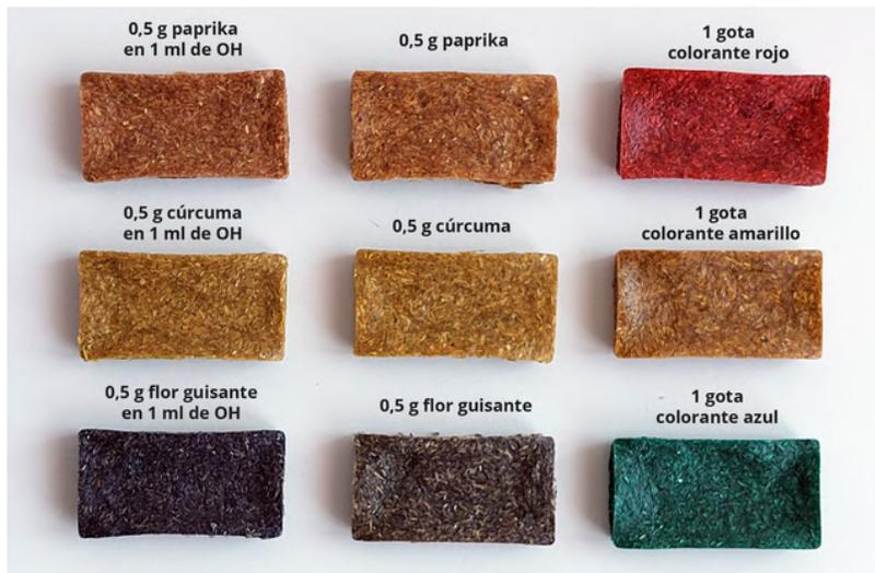
Figura 64: Coloración muestras posterior a secado. Elaboración propia.
