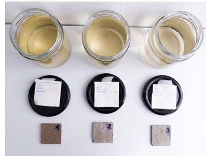
Figura 44: Muestras después de 24 horas de sumersión en agua. Elaboración propia.
