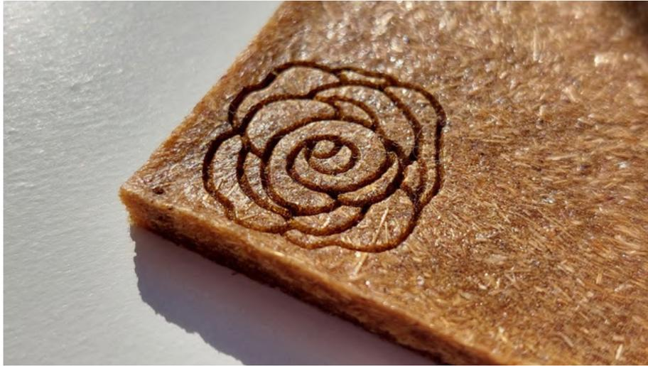
Figura 65: Resultado grabado de figura lineal. Elaboración propia.
