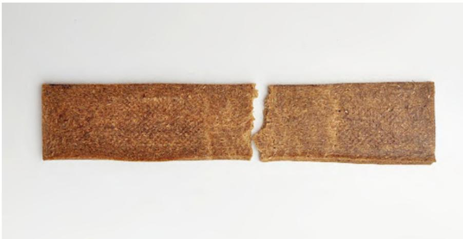
Figura 48: Muestra material compuesto luego del ensayo de tracción. Elaboración propia.
