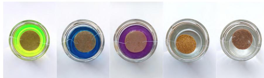
Figura 36: Muestras en ensayo reactivos químicos de inmersión. Elaboración propia.
