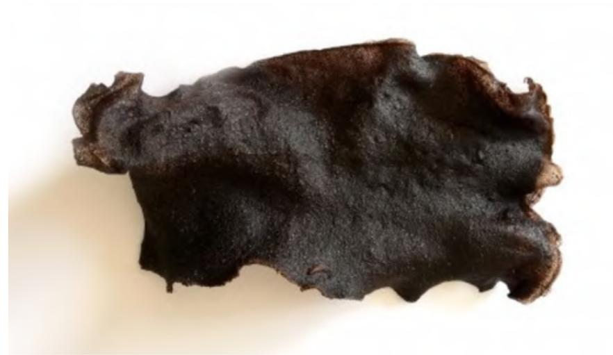
Figura 11: Textil elaborado a partir de fibra de coco. Fuente: (Materiom, 2021)
