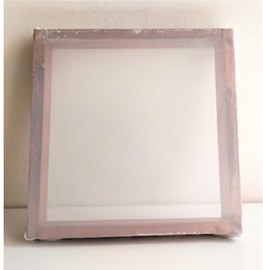
Figura 33: Bastidor con la tela tensada. Elaboración propia.
