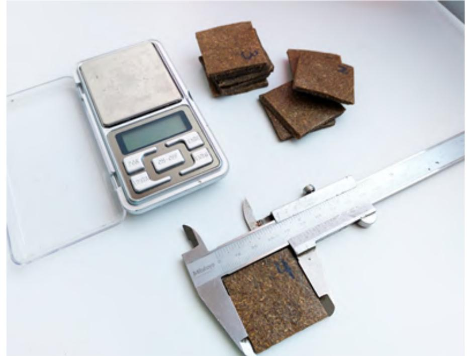
Figura 24: Implementos utilizados para medir la densidad, balanza gramera y pie de metro marca Mitutoyo. Elaboración propia.
