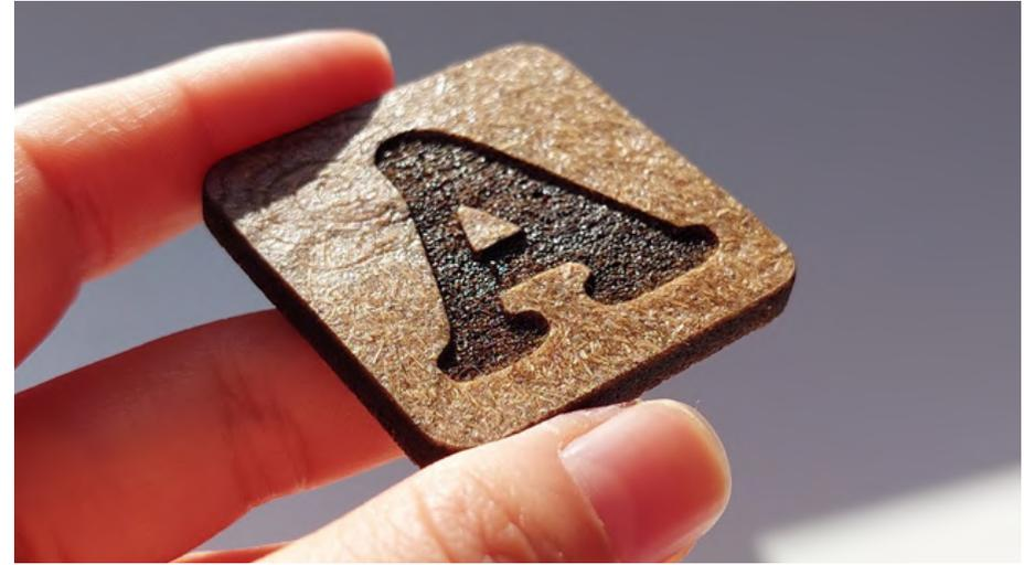
Figura 67: Resultado grabado espesor grueso y corte simple. Elaboración propia.
