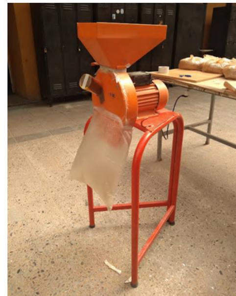
Figura 21: Molino de martillo G-Tools de Biolab FAU. Elaboración propia.
