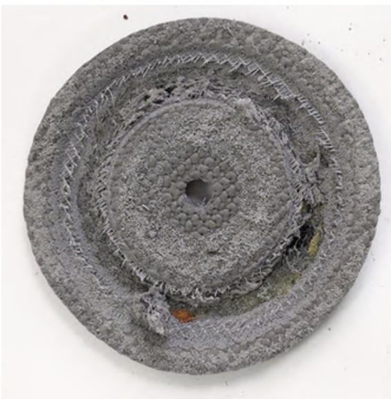
Figura 51: Muestra PVC luego de ensayo abrasión. Elaboración propia.
