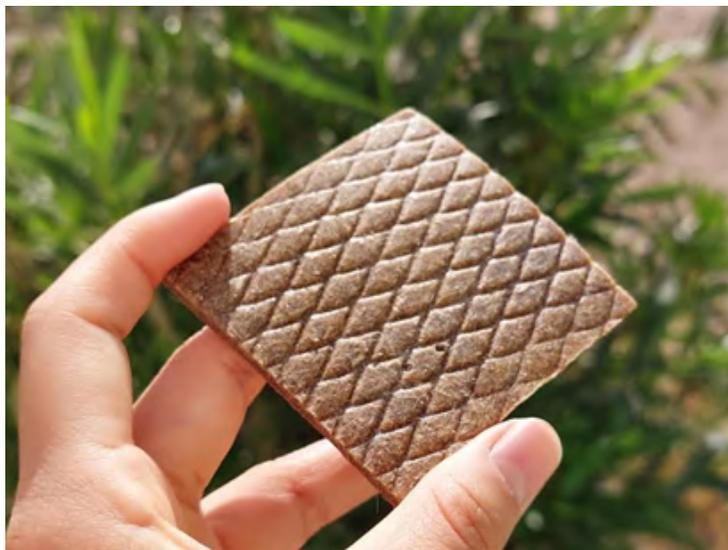
Figura 58: Resultado de muestra pasada por cilindadora de rodillos. Elaboración propia.
