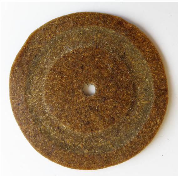
Figura 50: Muestra material compuesto luego de ensayo abrasión. Elaboración propia.
