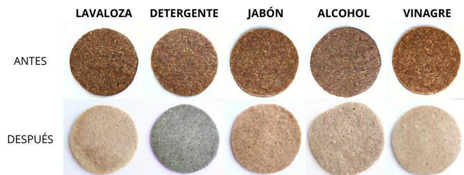
Figura 72: Muestras antes y después de ensayo de resistencia a reactivos químicos (inmersión). Elaboración propia.
