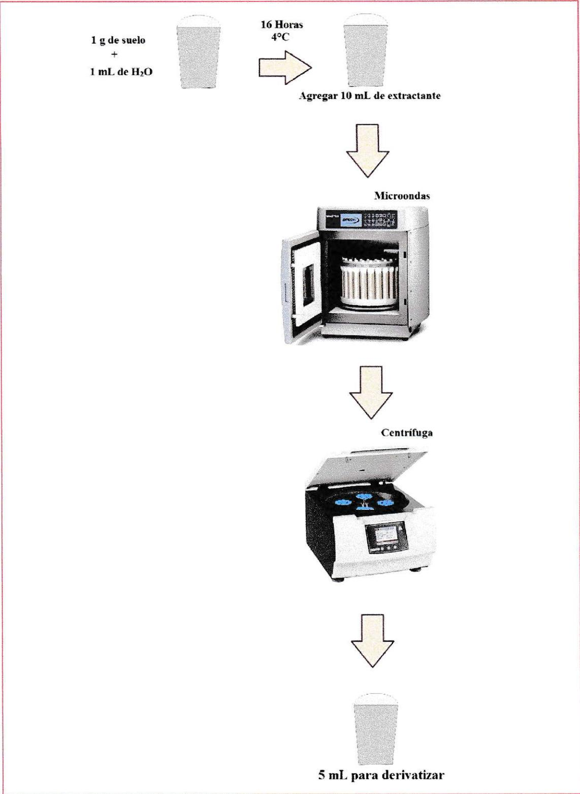
**Figura 7. Metodología de extracción de GPS y AMPA asistida por microondas**
