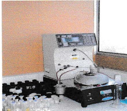
Figura 13: Determinación de inflamabilidad en residuos sólidos - Method 1030.
