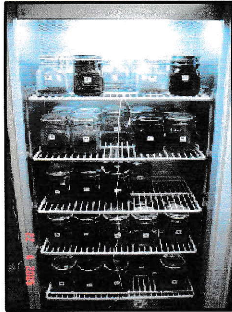
Figura 13: Incubación de las muestras de suelo (Incubadora Sanyo Incubator MIR-253).
