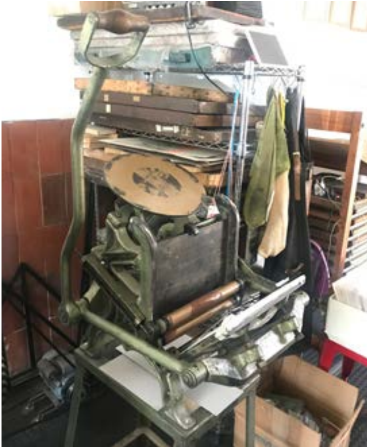
Figura 108. Imagen de prensa letterpress utilizada para imprimir los números en las cartas. Taller Tipo Móvil. Ñuñoa santiago.
