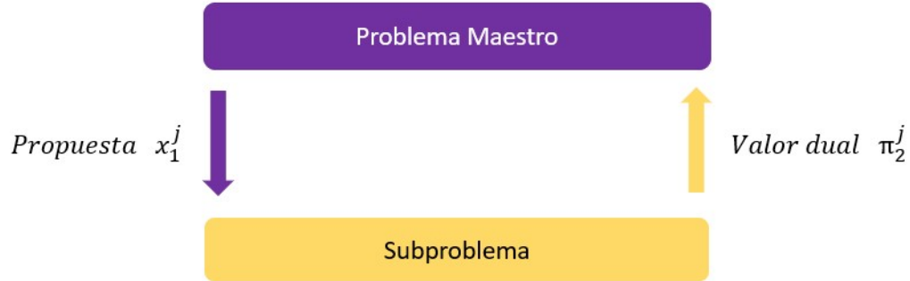
Figura 2.10: Esquema de alternancia entre los problemas maestro y subproblema del método de Benders.
