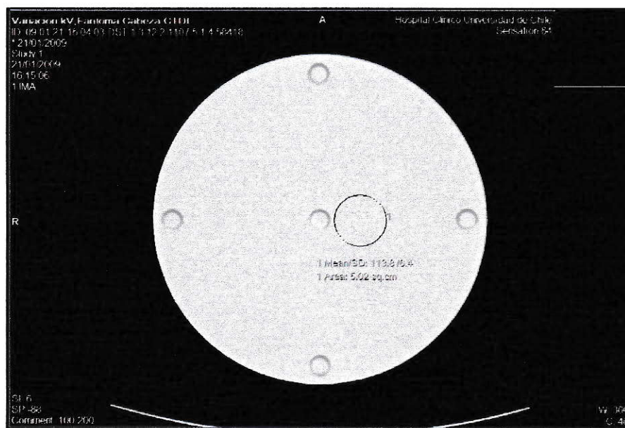
Figura 9. Localización de la ROI para medición de ruido en fantoma de CTDI.
