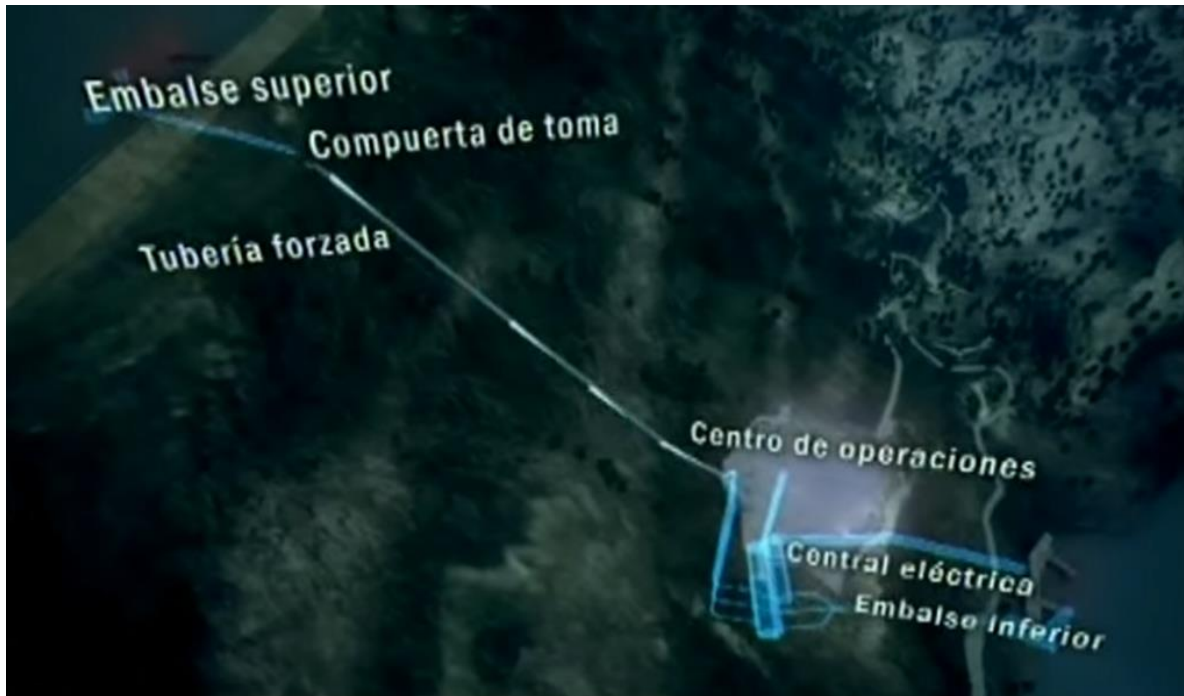
Figura 29: Composición de la central La Muela II. Fuente: Iberdrola Youtube Channel.
