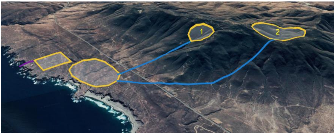
Figura 64: Reservorios superiores (1 y 2), reservorio inferior (óvalo inferior) y planta desalinizadora (rectángulo). Fuente: Elaboración propia obtenida de Google Earth.
