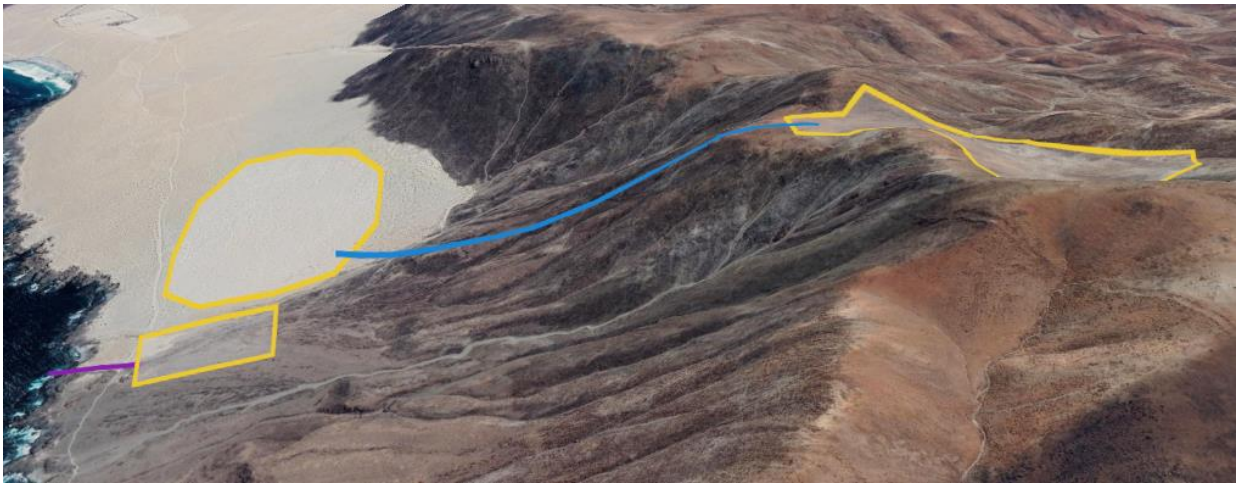
Figura 107: Desnivel y tubería de caída entre reservorios. Fuente: Elaboración propia obtenida de Google Earth.
