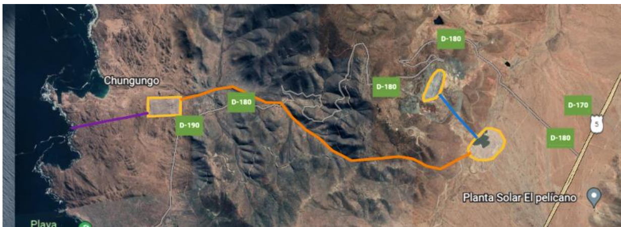
Figura 94: Vista en planta de la central. Reservorios y desalinizadora (amarillo), tubería forzada de caída (azul), tubería de impulsión (naranja) y tubería de captación (morado). Fuente: Elaboración propia obtenida de Google Earth.
