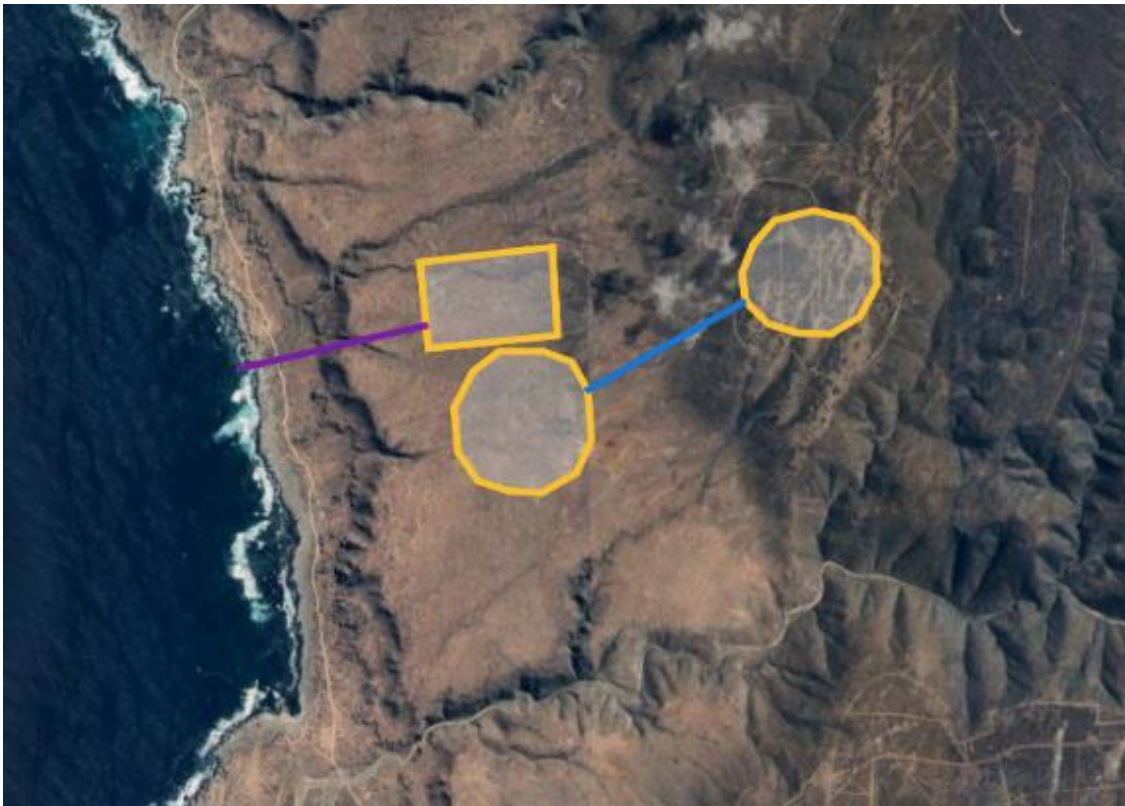
Figura 85: Vista en planta reservorio superior, inferior (circunferencias) y planta desalinizadora (rectángulo). Fuente: Elaboración propia obtenida de Google Earth.
