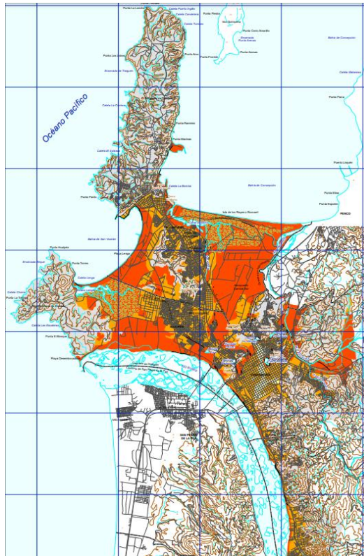
Figura 3.3: Peligro de licuefacción en zona de emplazamiento del proyecto
