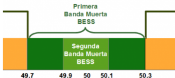
Figura 3.7: Banda muerta de operación del BESS.
