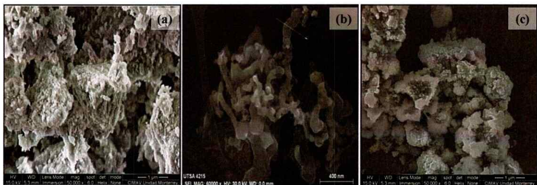
Figura 11. Imágenes SEM realizadas a una escala de 400nm y 1µm: (a) Zeolita, (b) nZVI y (c) ZN-50%.
