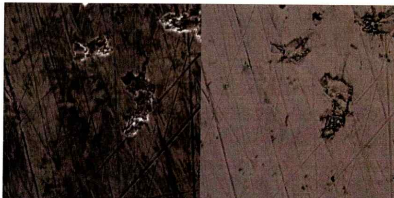
Figura 54. Imágenes SEM-ES y SEM-BS del pellet sinterizado para la fase \text{AgSn}_{16}\text{SbSe}_2\text{Te}_{16} , antes del programa de calentamiento.
