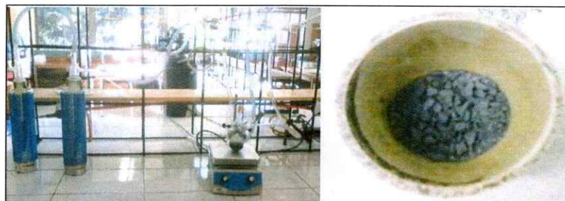
Figura 10. Secado a vacío del precursor molecular y producto obtenido.
