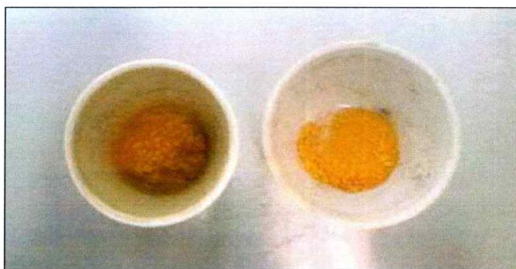
Figura 11. Resultado de la pirólisis a 400°C por 6 horas de los precursores moleculares (1:5).
