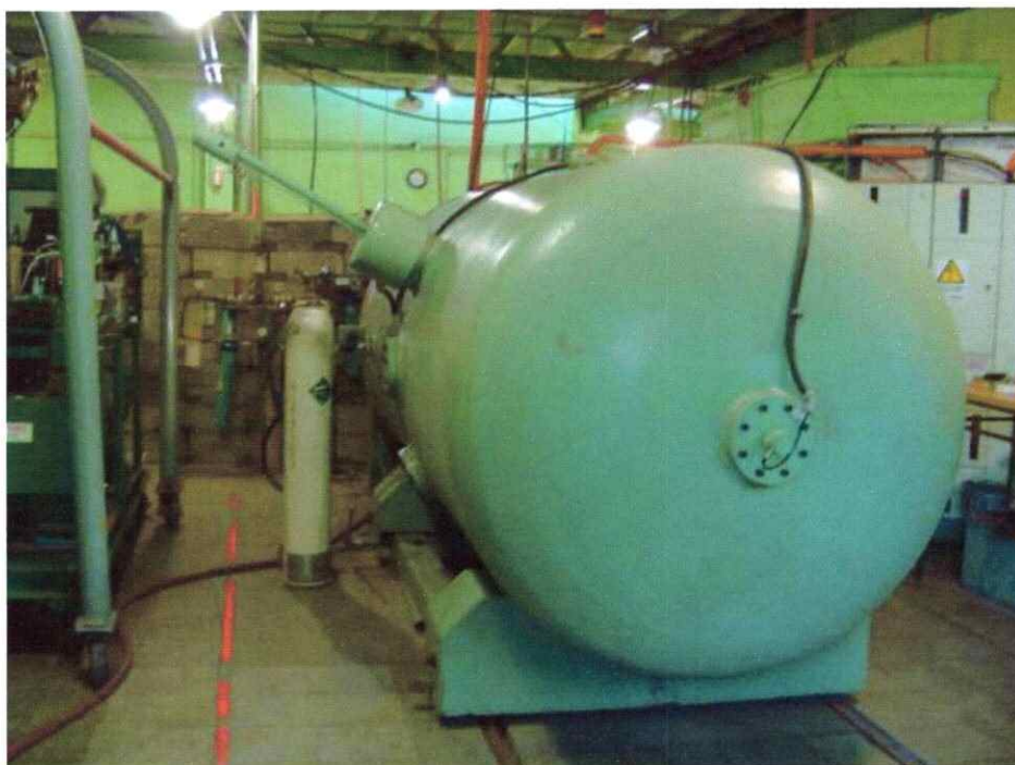
Figura 3.1: Vista posterior del acelerador VdG KN3750. En esta fotografía el tanque contenedor está siendo presurizado con un gas aislante ( \text{SF}_6 ) entorno del generador de alta tensión y del sistema de aceleración.
