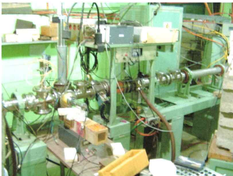
Figura A.3: Fotografía del montaje utilizado durante la irradiación de protones en una muestra delgada de \text{CaF}_2
