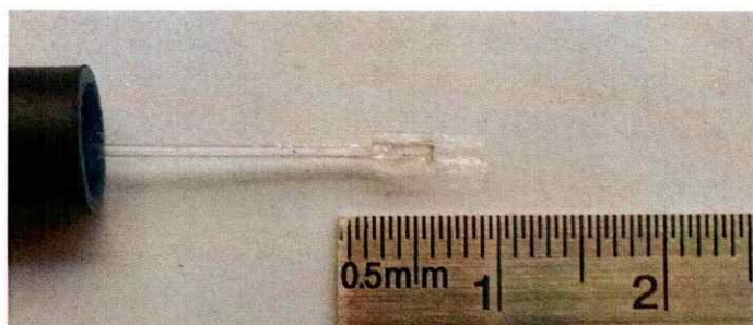
Fig. 12. Portamuestra que en un extremo de la varilla de cuarzo posee un vidrio para montar la muestra, y el otro esta adherido a un piezoeléctrico
