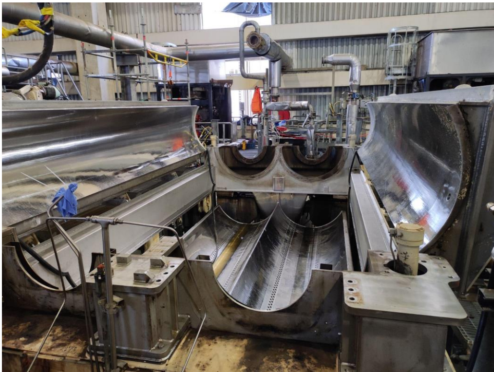
Figura 2.6: Batea de una prensa de desplazamiento.
