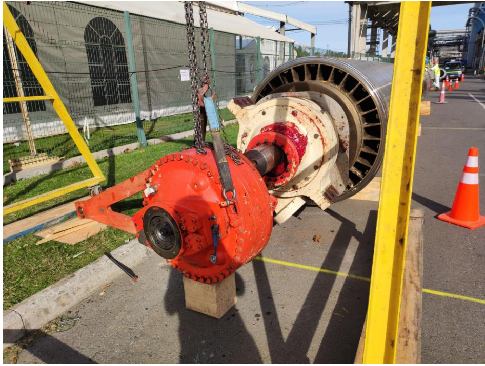
Figura 2.5: Motor hidráulico (de color naranja) y rodillo en el fondo.
