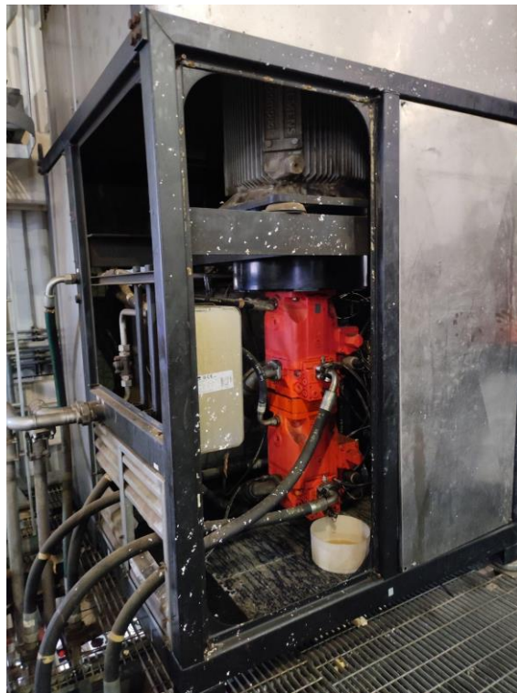
Figura 2.8: Unidad hidráulica encargada de accionar los rodillos de una prensa.
