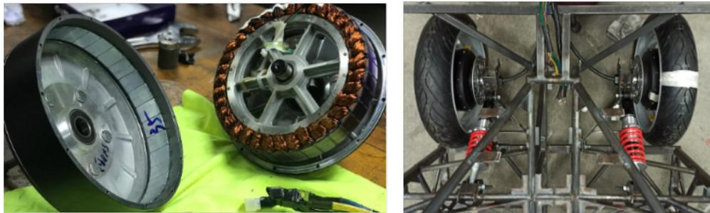
Figura 4.2: A la izquierda, el motor *Qs* desarmado entre estator-armadura y rotor *PM*. A la derecha, la instalación inicial de motores con llantas en tracción trasera del vehículo.
