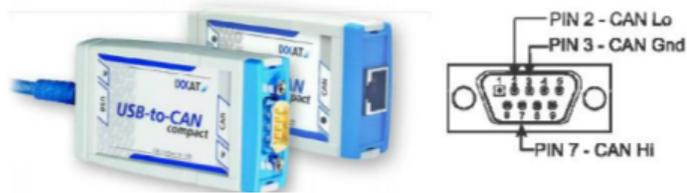
Figura 2.14: Adaptador *CAN* to *USB IXXAT* y *pinout* [6].
