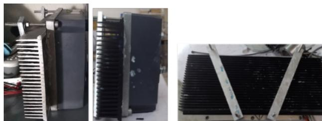
Figura 4.10: Disipadores de aluminio instalados en la base de aluminio del inversor *Sevcon*.
