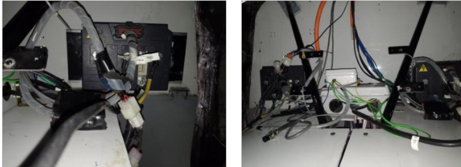
Figura 4.6: Inversores *Sevcon* instalados en el chasis trasero del vehículo.
