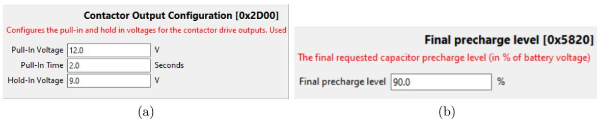
Figura D.12: Registro de configuración de las características eléctricas del contactor.
