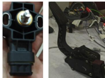
Figura 4.9: En la izquierda el pedal del freno regenerativo y a la derecha el acelerador conectado al inversor.
