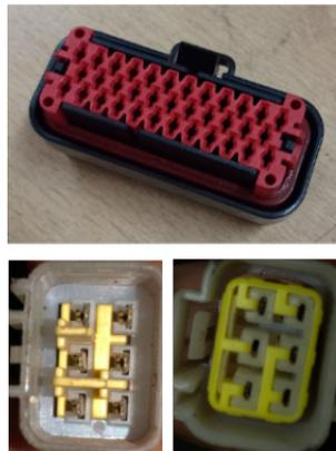
Figura 4.7: Conector de 35 pines para circuito de mando y conectores macho-hembra para sensores de posición.
