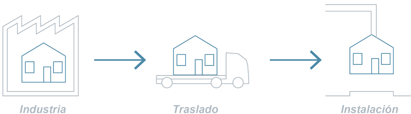
Esquema: Etapas construcción industrializada Fuente: Elaboración propia
