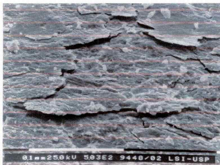
Figura 4.24 Micrografía del compuesto de intercalación de K_2[Pt(CN)_4]_{0.03} V_2O_5
