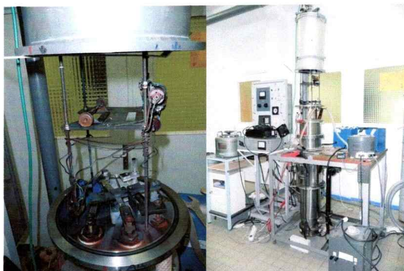
Figura 2-11. Equipo de evaporación al vacío
