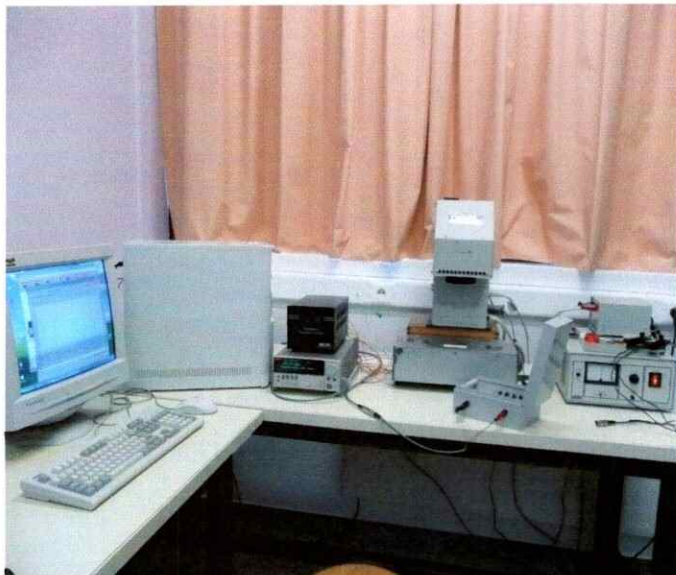
Figura 2-13. Equipo de simulación solar
