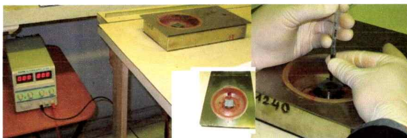
Figura 2-2. Técnica de spin coating . A la derecha, spinner y, a la izquierda, el depósito de polímero sobre ITO glass .
