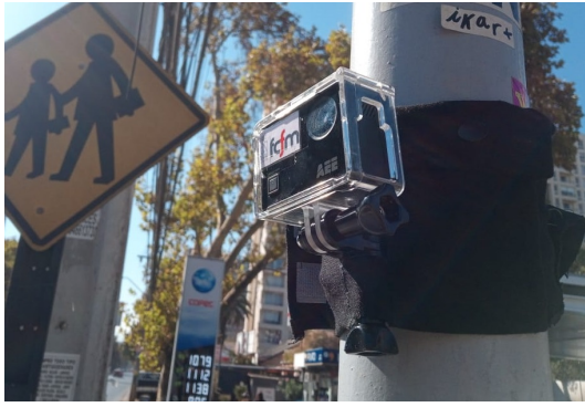
(a) Instalación de la cámara deportiva en un poste.
