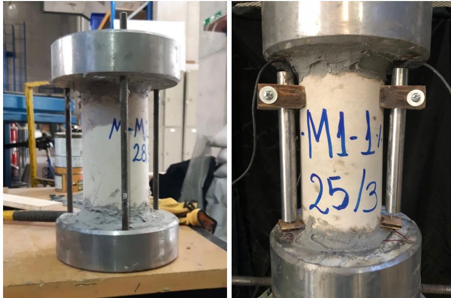
Figura 3.7: Montaje de ensayo a tracción
