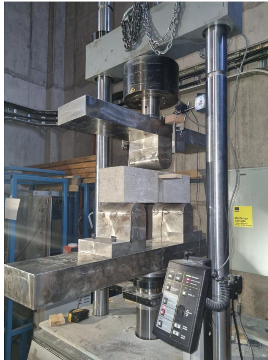
Figura 3.10: Montaje ensayo a flexión de 3 puntos
