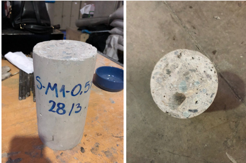
Figura 3.8: Rectificado de probetas cilíndricas
