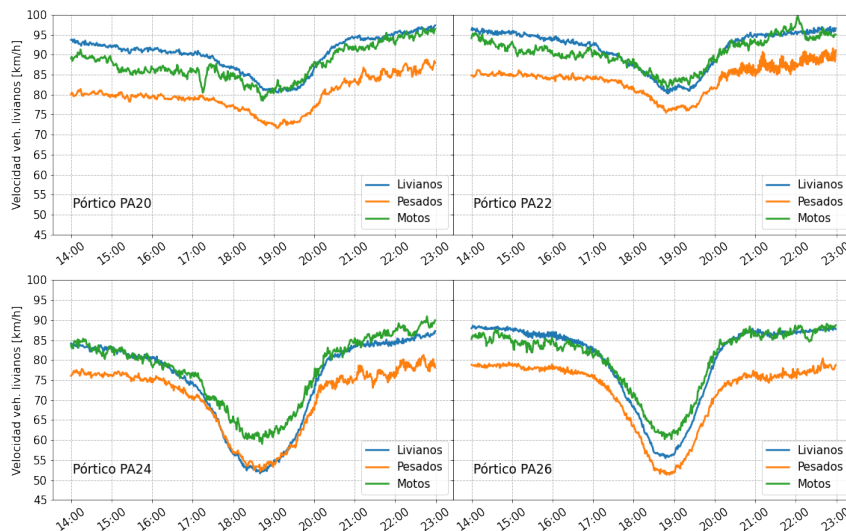
Figura 5.2: Velocidad promedio para cada tipo de vehículo y para cada pórtico.
