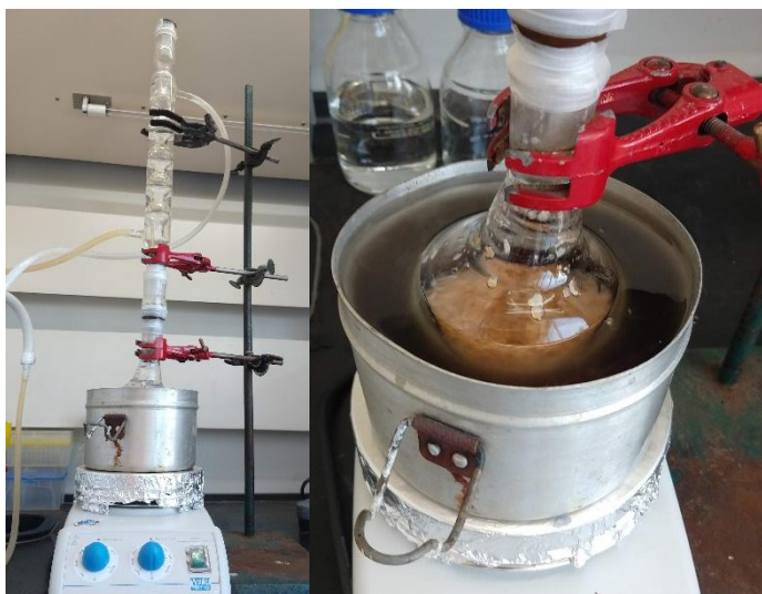
Imagen 1: Montaje experimental para la hidrólisis alcalina del material celulósico. A la izquierda se observa que el balón de destilación que contiene el material a hidrolizar se encuentra al interior de un baño térmico y sobre un agitador magnético, y que se encuentra unido a un condensador para mantener constante la concentración de la solución durante el proceso. La imagen de la derecha muestra el interior del balón con el material celulósico cargado. Se mantiene bajo el nivel del baño térmico para asegurar una temperatura homogénea en todo el material.
