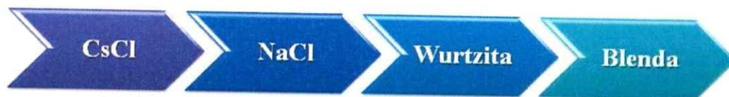
entonces las estructuras tipo blenda de zinc son "más covalentes", que las tipo wurtzita. Si aplicamos estas generalidades en los sulfuros cuaternarios  $\text{Cu}_2\text{M}^{\text{II}}\text{M}^{\text{IV}}\text{S}_4$  podemos proponer que las estructuras que presenten una mayor diferencia de electronegatividad, tendrán un carácter menos covalente y por lo tanto, presentan estructuras tipo Wurtzita.
