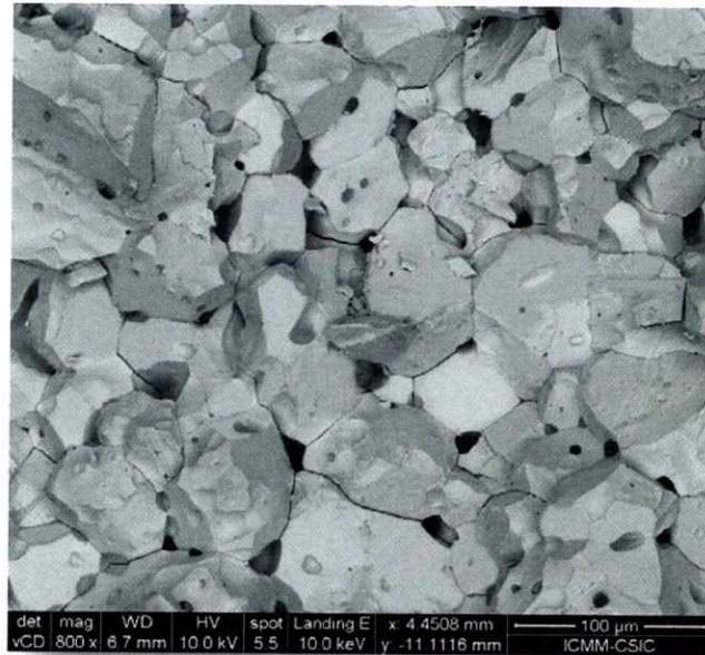
**Figura 3. 22** Fractura mixta (intra e intergranular) de  $\text{Cu}_2\text{MnSnS}_4$  sinterizada a  $800^\circ\text{C}$ , alcanza un 92% de densificación, el tamaño de grano aumento entre 60 a 100  $\mu\text{m}$ , se observa la aparición de poros.
