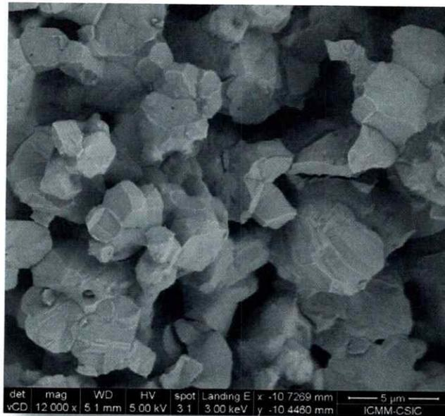
**Figura 3. 20** *Fractura mixta (intra e intergranular) de  $\text{Cu}_2\text{MnSnS}_4$  sinterizada a 700°C, alcanza un 80% de densificación, el tamaño de grano oscila entre 3 a 5  $\mu\text{m}$ .*
