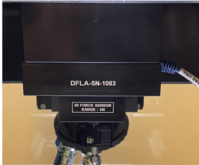
Figura 3.6: Sensor de fuerza 2D con un rango de carga máxima de hasta 5 N, localizado en el tribómetro multifuncional [47].
