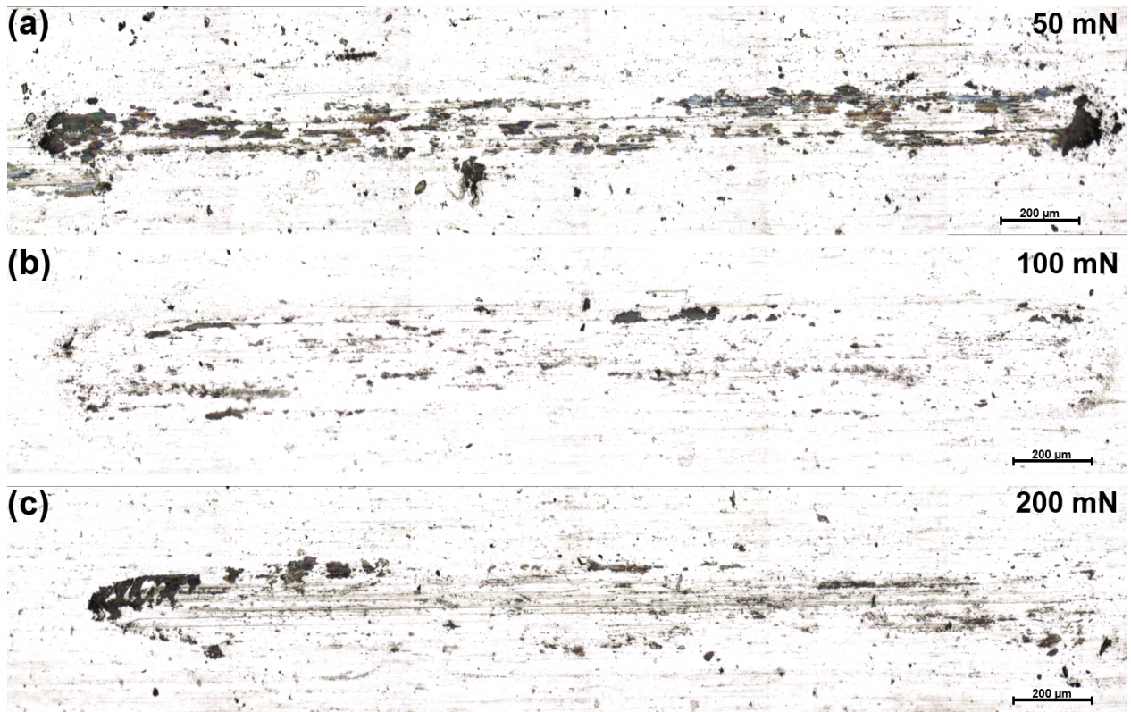
Figura B.1: Pistas de desgaste para el sustrato de acero inoxidable sin recubrimiento para las siguientes cargas normales: 50 mN (a); 100 mN (b); 200 mN (c).
