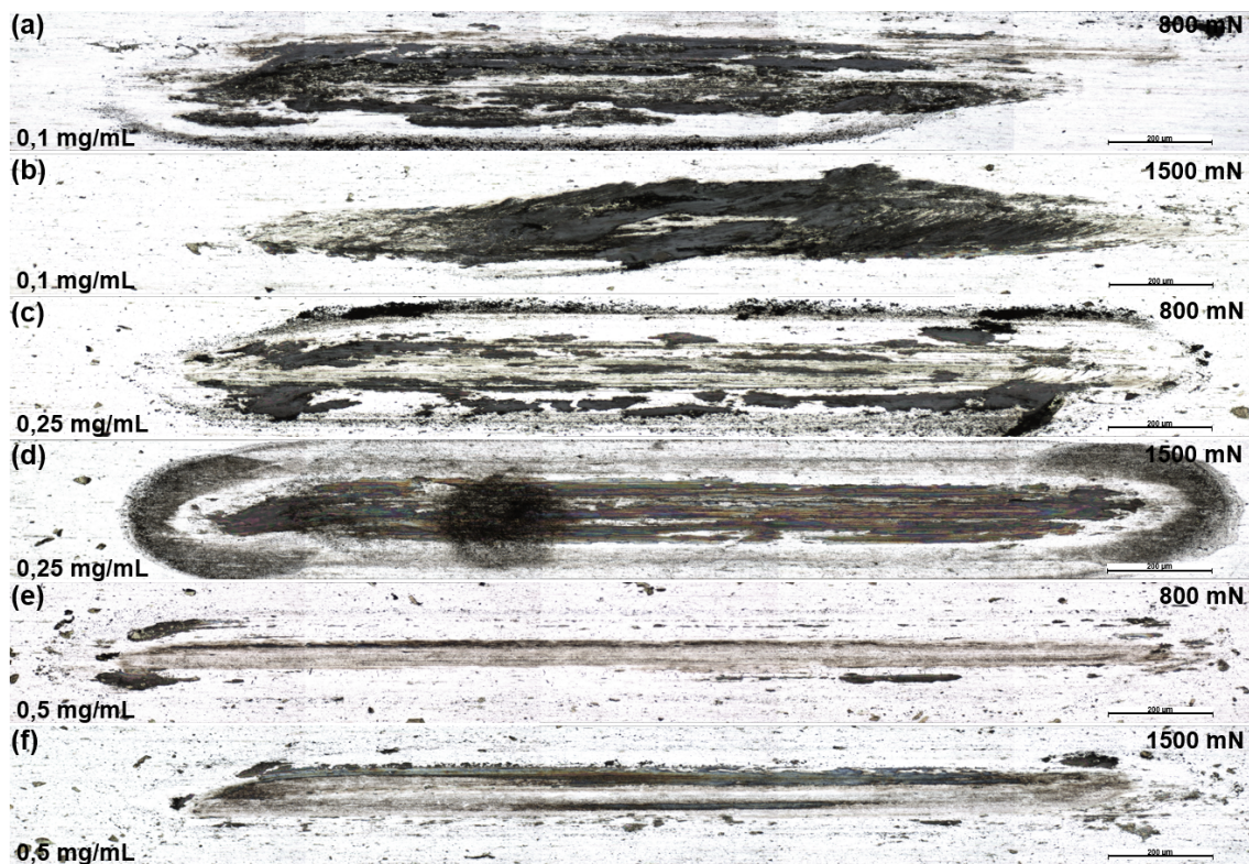
Figura 4.12: Pistas de desgaste del TiS_2 P a una concentración de 0,1 \frac{mg}{mL} para las siguientes cargas normales: 800 mN (a); 1500 mN (b). Pistas de desgaste del TiS_2 P a una concentración de 0,25 \frac{mg}{mL} para las siguientes cargas normales: 800 mN (c); 1500 mN (d). Pistas de desgaste del TiS_2 P a una concentración de 0,5 \frac{mg}{mL} para las siguientes cargas normales: 800 mN (e); 1500 mN (f).
