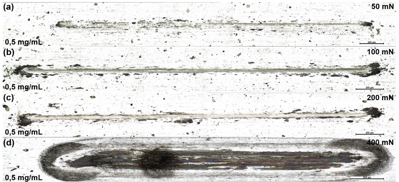
Figura B.2: Pistas de desgaste del \text{TiS}_2 P a una concentración de 0,5 \frac{\text{mg}}{\text{mL}} para las siguientes cargas normales: 50 mN (a); 100 mN (b); 200 mN (c); 400 mN (d).
