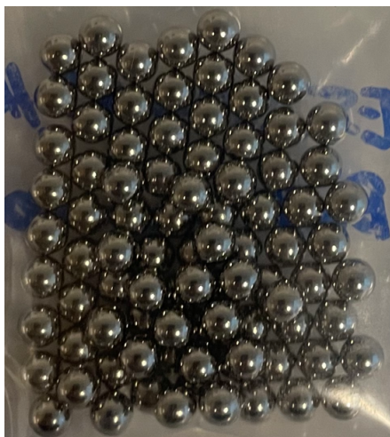
Figura 3.5: Bolas de acero usadas como cuerpo encargado de aplicar la carga normal sobre el recubrimiento para dar origen a pistas de desgaste.
