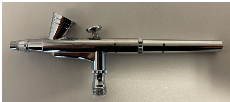
Figura 3.4: Aerógrafo utilizado en la fabricación de los recubrimientos de ambos compuestos a distintas concentraciones.
