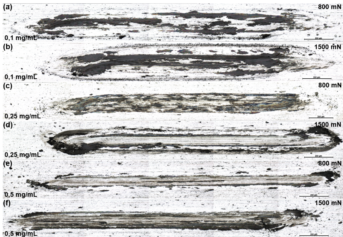
Figura 4.14: Pistas de desgaste del TiS_2 OA a una concentración de 0,1 \frac{mg}{mL} para las siguientes cargas normales: 800 mN (a); 1500 mN (b). Pistas de desgaste del TiS_2 OA a una concentración de 0,25 \frac{mg}{mL} para las siguientes cargas normales: 800 mN (c); 1500 mN (d). Pistas de desgaste del TiS_2 OA a una concentración de 0,5 \frac{mg}{mL} para las siguientes cargas normales: 800 mN (e); 1500 mN (f).
