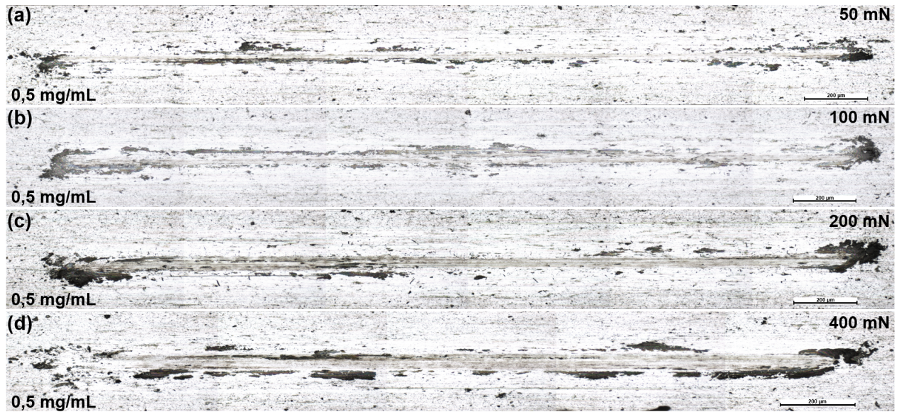
Figura B.6: Pistas de desgaste del \text{TiS}_2 OA a una concentración de 0,5 \frac{\text{mg}}{\text{mL}} para las siguientes cargas normales: 50 mN (a); 100 mN (b); 200 mN (c); 400 mN (d).
