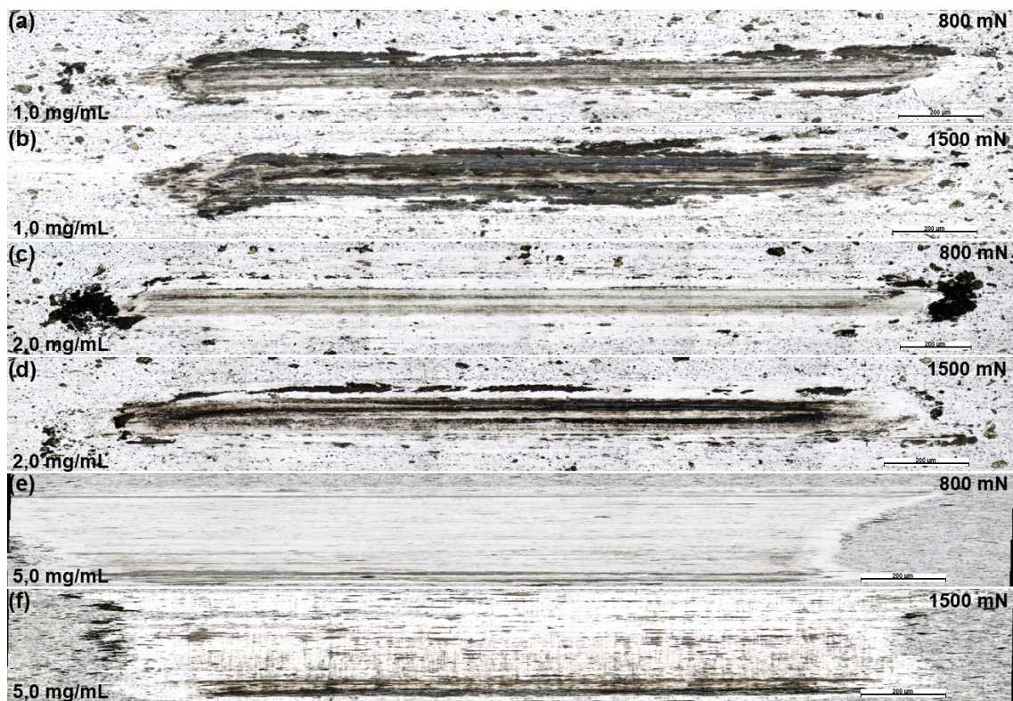
Figura 4.13: Pistas de desgaste del TiS_2 P a una concentración de 1,0 \frac{mg}{mL} para las siguientes cargas normales: 800 mN (a); 1500 mN (b). Pistas de desgaste del TiS_2 P a una concentración de 2,0 \frac{mg}{mL} para las siguientes cargas normales: 800 mN (c); 1500 mN (d). Pistas de desgaste del TiS_2 P a una concentración de 5,0 \frac{mg}{mL} para las siguientes cargas normales: 800 mN (e); 1500 mN (f).
