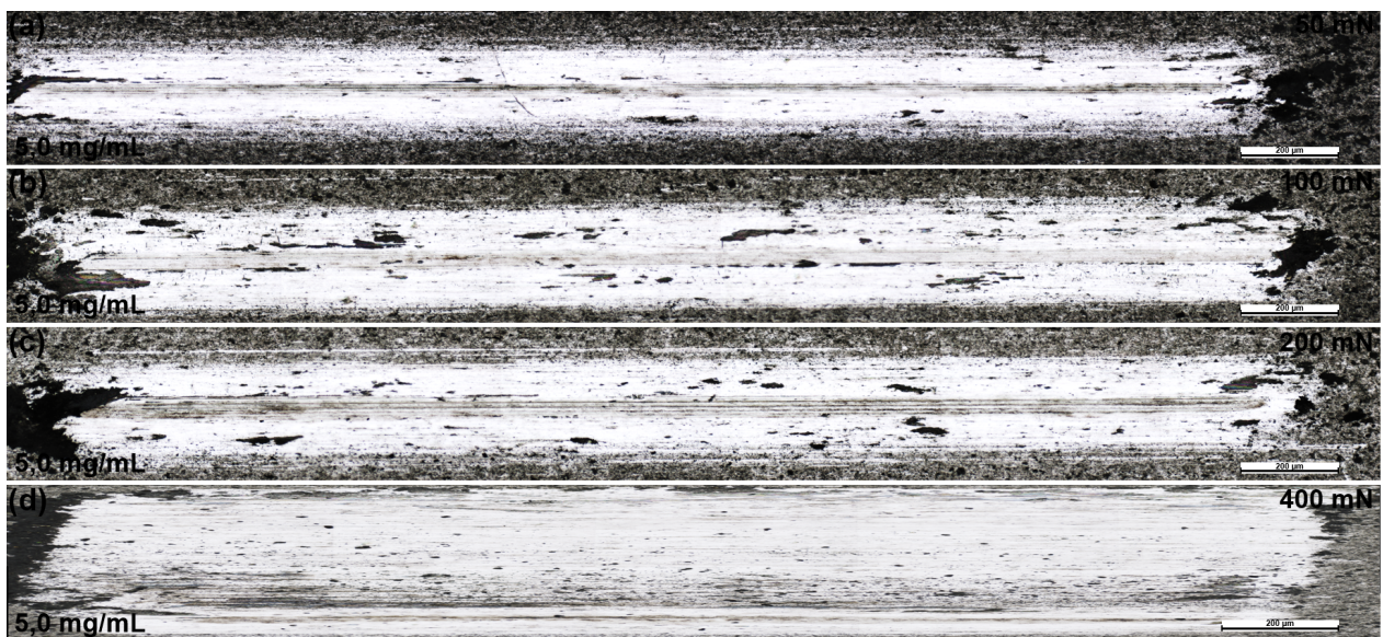
Figura B.9: Pistas de desgaste del \text{TiS}_2 OA a una concentración de 5,0 \frac{\text{mg}}{\text{mL}} para las siguientes cargas normales: 50 mN (a); 100 mN (b); 200 mN (c); 400 mN (d).
