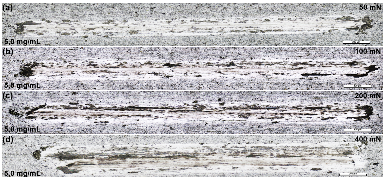
Figura B.5: Pistas de desgaste del \text{TiS}_2 P a una concentración de 5,0 \frac{\text{mg}}{\text{mL}} para las siguientes cargas normales: 50 mN (a); 100 mN (b); 200 mN (c); 400 mN (d).
