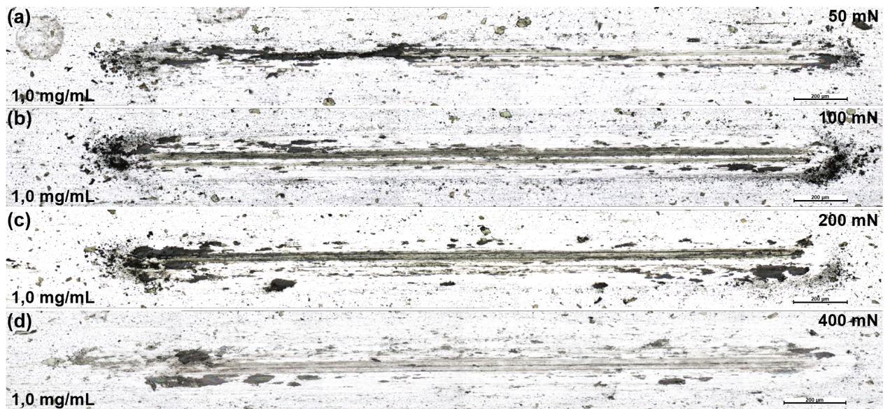
Figura B.3: Pistas de desgaste del \text{TiS}_2 P a una concentración de 1,0 \frac{\text{mg}}{\text{mL}} para las siguientes cargas normales: 50 mN (a); 100 mN (b); 200 mN (c); 400 mN (d).
