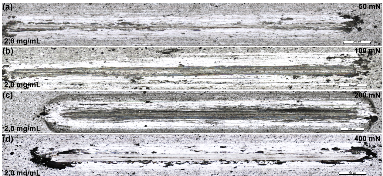
Figura B.8: Pistas de desgaste del \text{TiS}_2 OA a una concentración de 2,0 \frac{\text{mg}}{\text{mL}} para las siguientes cargas normales: 50 mN (a); 100 mN (b); 200 mN (c); 400 mN (d).
