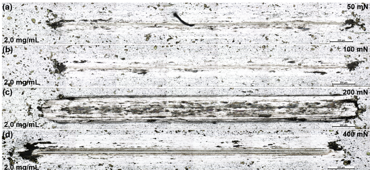
Figura B.4: Pistas de desgaste del \text{TiS}_2 P a una concentración de 2,0 \frac{\text{mg}}{\text{mL}} para las siguientes cargas normales: 50 mN (a); 100 mN (b); 200 mN (c); 400 mN (d).
