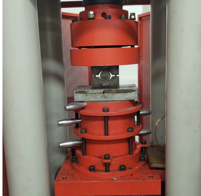
Figura 3.5: Instrumentación utilizada en los ensayos de tracción indirecta con el método brasileño.
