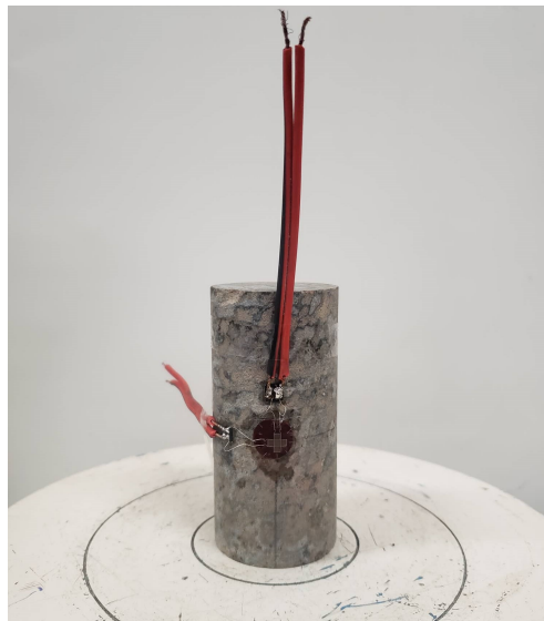
Figura 3.3: Probeta UCS ya instrumentada (Fuente: Elaboración propia).
