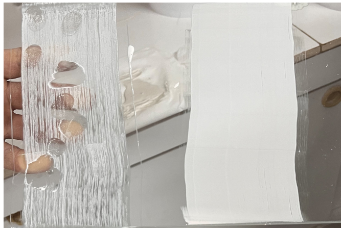
Figura 3.4: Comparación tiempo abierto pasta prototipo (izquierda) y original (derecha).
