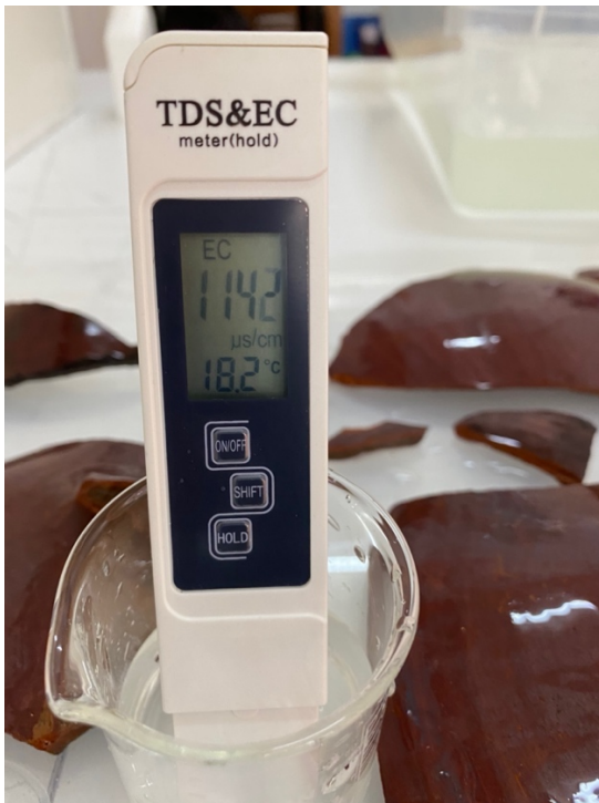
Fotografías N° 114 - 115: Imagen general y en detalle del proceso de lavado dinámico por inmersión de fragmentos cerámicos con eflorescencia salina y del sistema de registro con conductímetro.
