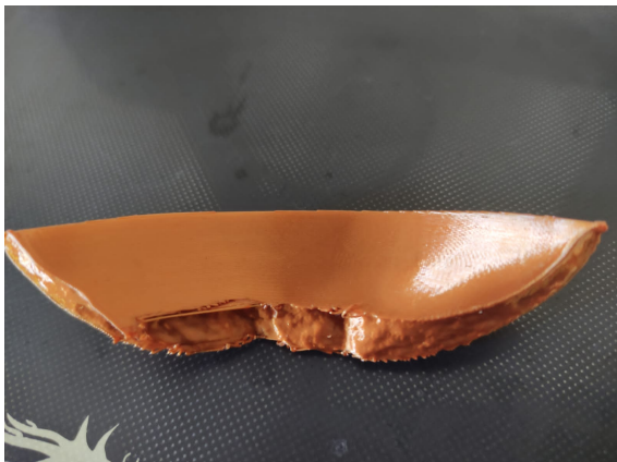
Fotografías N° 34-35-36-37-38-39: Imágenes detallan el proceso de impresión 3D del fragmento que será utilizado para la reintegración volumétrica.
