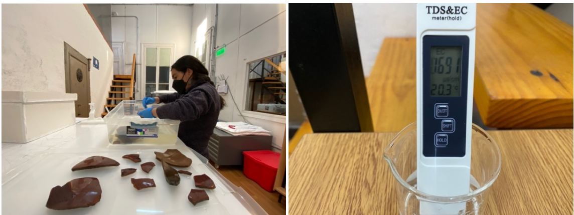
Fotografías N° 110 - 111: Imagen genera y en detalle del proceso de lavado dinámico por inmersión de fragmentos cerámicos con eflorescencia salina y del sistema de registro con conductímetro.
