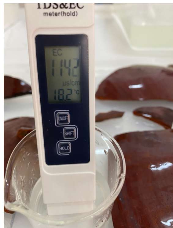
Fotografías N° 112 - 113: Imagen genera y en detalle del proceso de lavado dinámico por inmersión de fragmentos cerámicos con eflorescencia salina y del sistema de registro con conductímetro.
