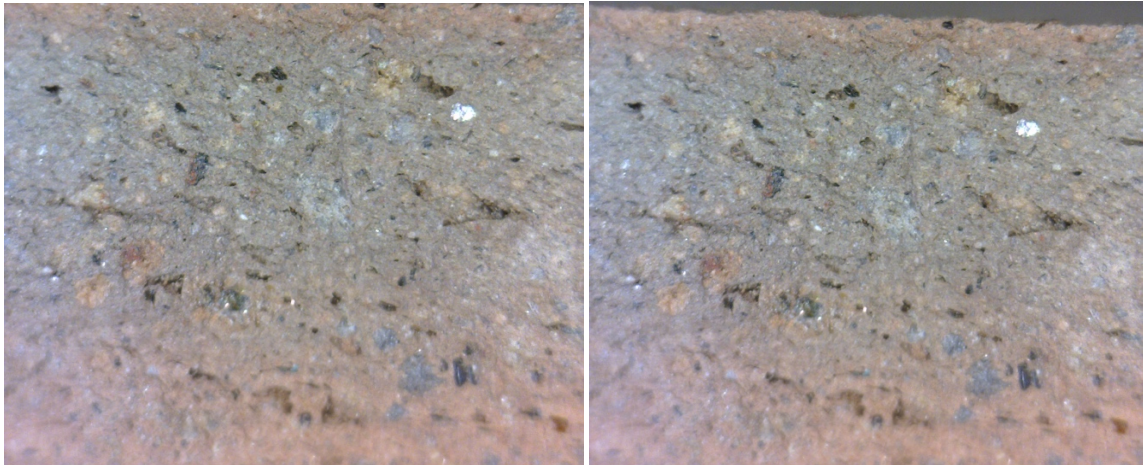
Fotografías N° 92 - 93: Imágenes obtenida de microscopio digital Dino Lite pro, donde se logra apreciar claramente la diferencia en la tonalidad de la pasta.
