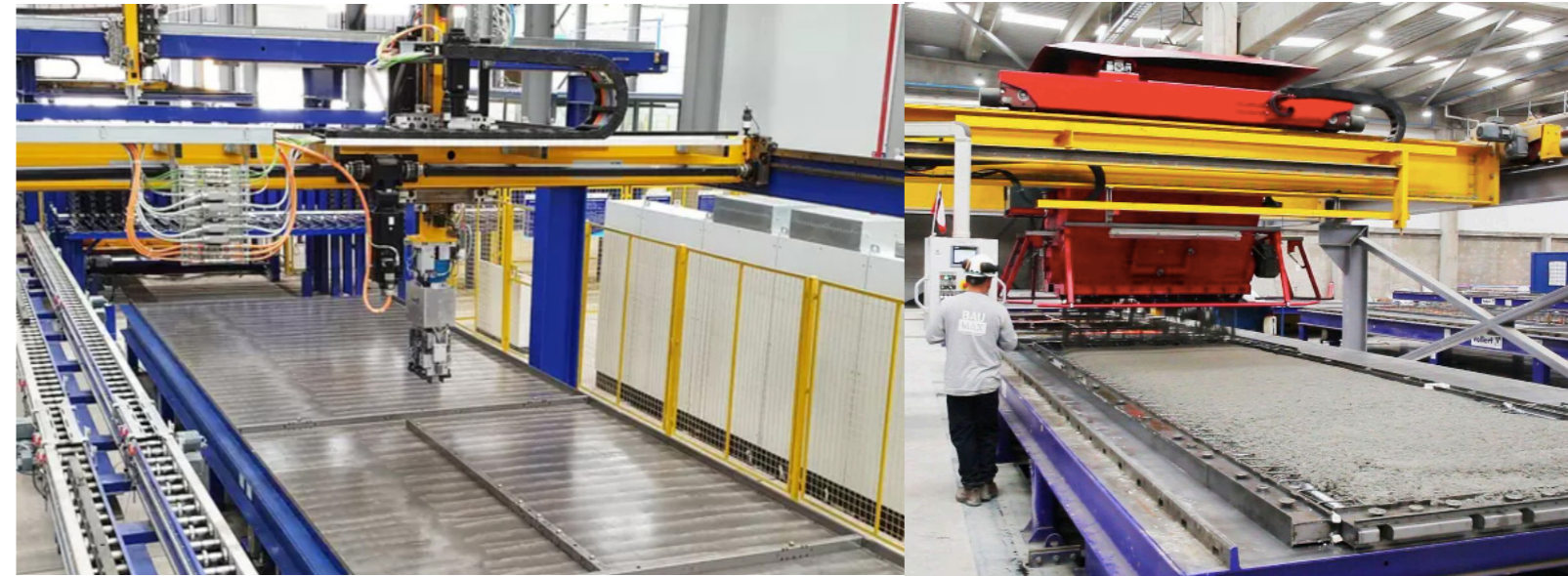
Figura 17. Fotografías de brazo robótico de maquinaria y proceso de vertido de hormigón y cubrimiento de enfierradura respectivamente, para la construcción automatizada del hormigón armado en Chile en la empresa Baumax. (BAUMAX, 2021)
