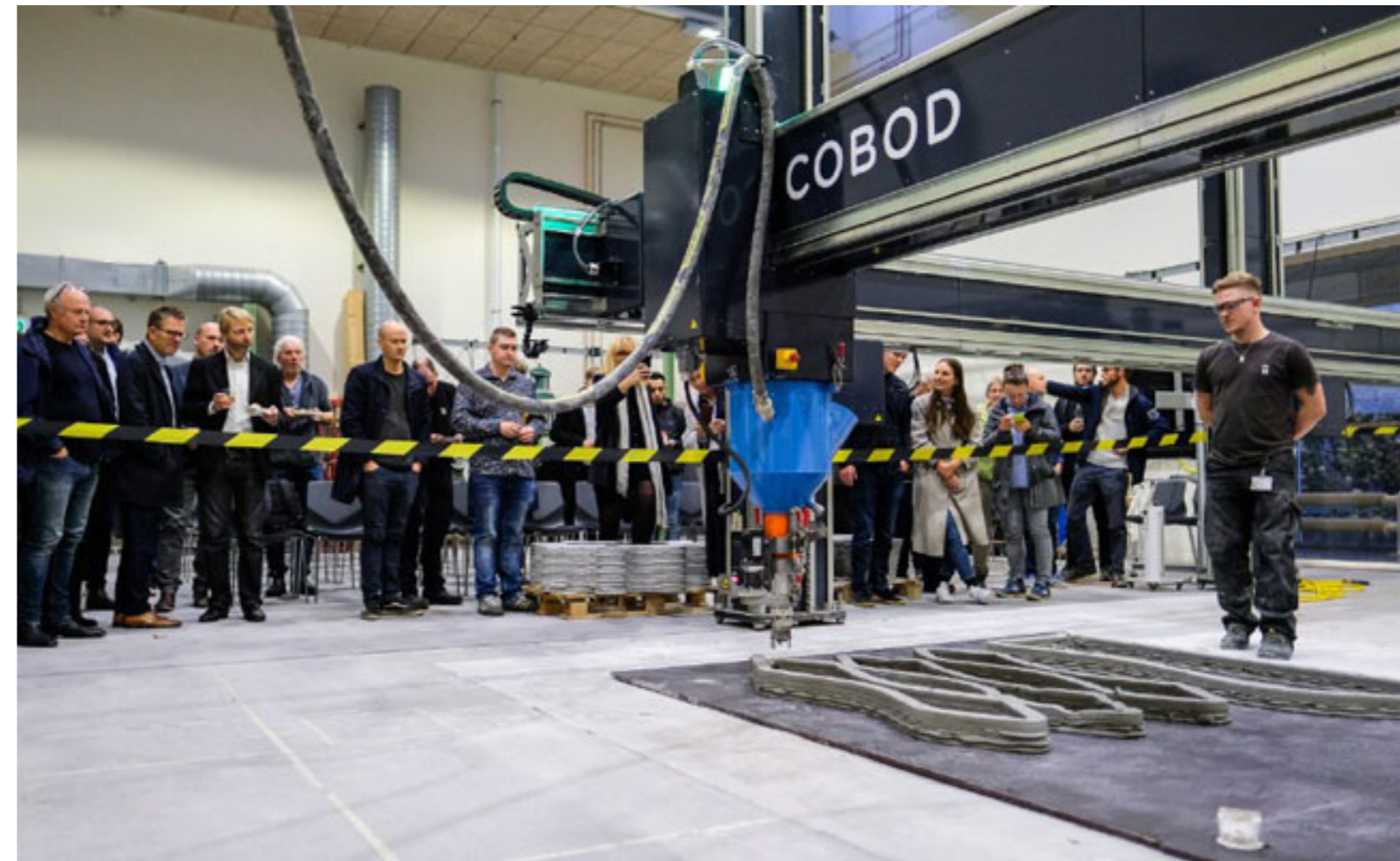
Figura 21. Impresora de hormigón de la empresa COBOD. Fuente: web 3dnatives.
