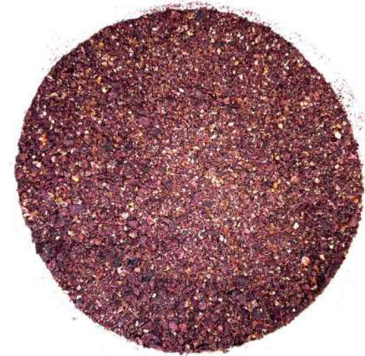
Figura 28: Orujo de uva molido en Molino Martillo
