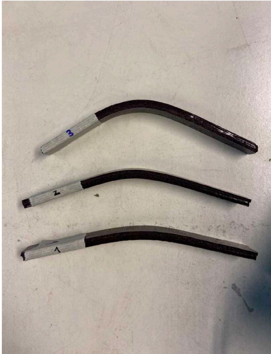
Figura 40: Probeta de Flexión 1, 2 y 3 volviendo a su forma. Fuente: Elaboración propia
