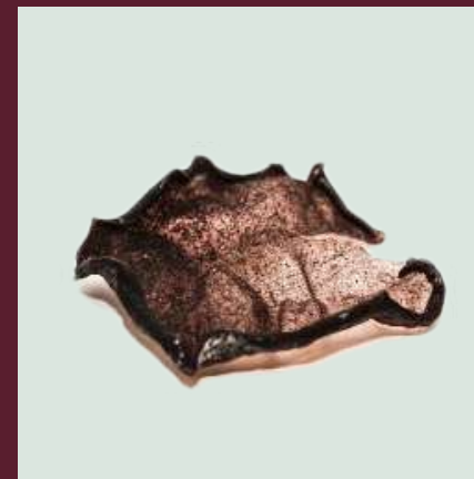
Figura 13: Borde de material orujo y agar agar Fuente: Elaboración propia a partir de Materiom (s.f.).
