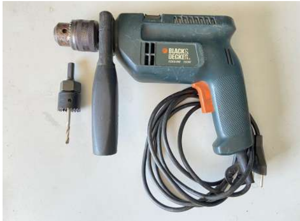
Figura 21: Taladro utilizado en ensayo de perforación. Fuente: Elaboración propia
