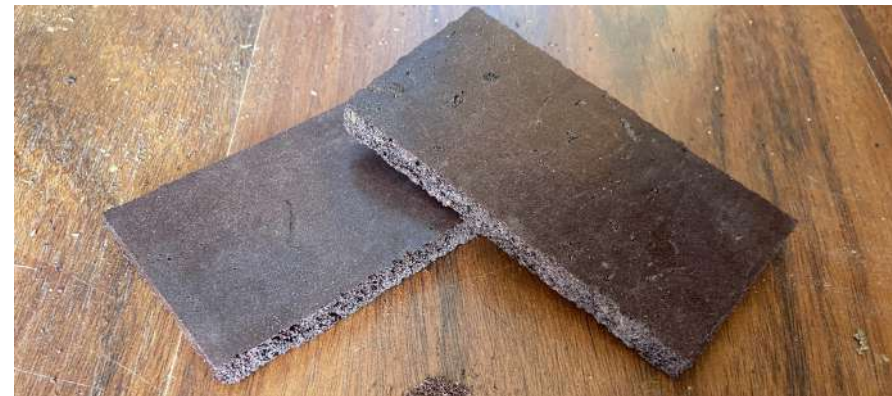
Figura 50: Ensayo de corte con caladora. Fuente: Elaboración propia
