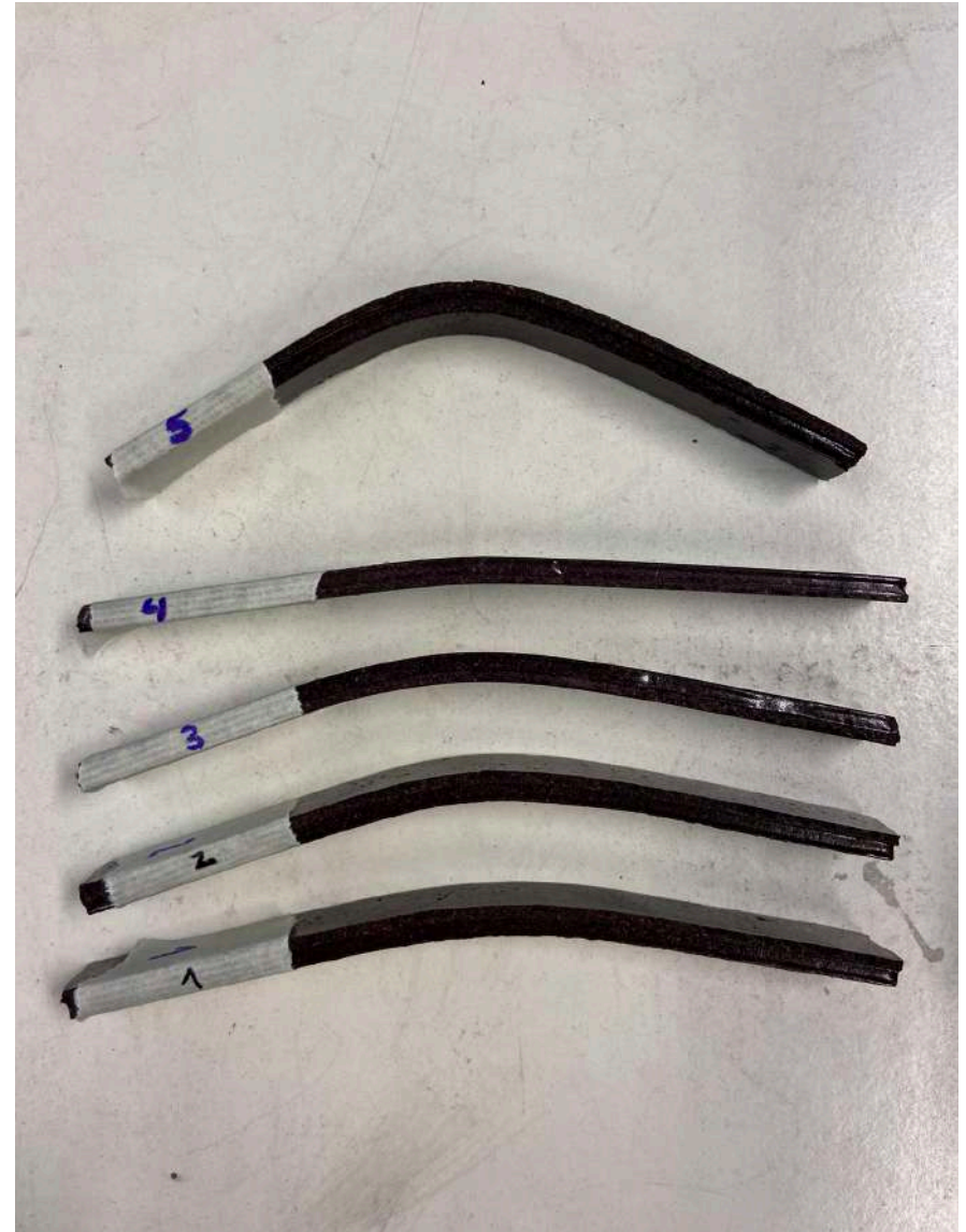
Figura 41: Probeta de Flexión 1, 2, 3, 4 y 5 volviendo a su forma. Fuente: Elaboración propia
