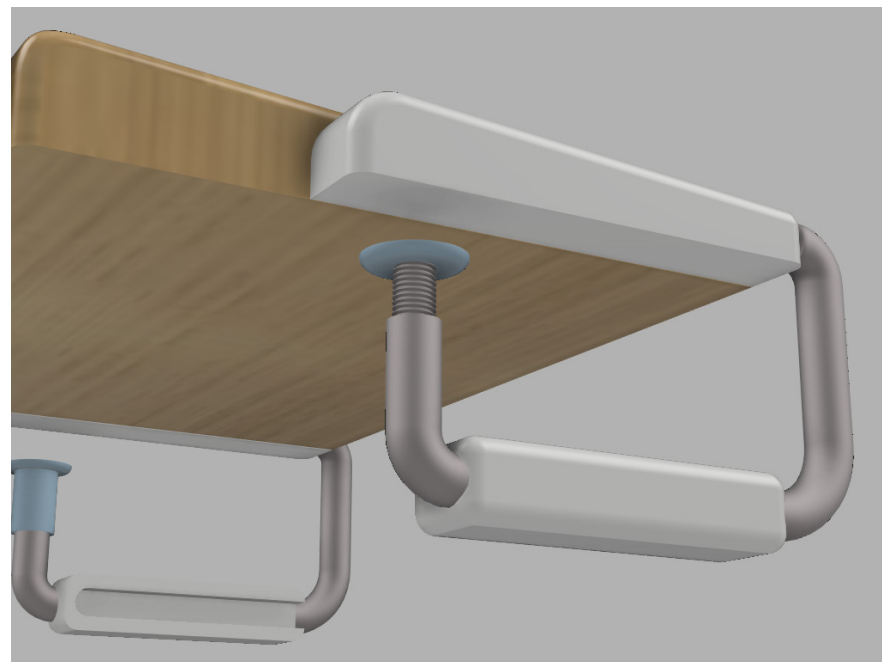
Figura 53. Render primera propuesta de mecanismo de sujeción. Elaboración propia.
