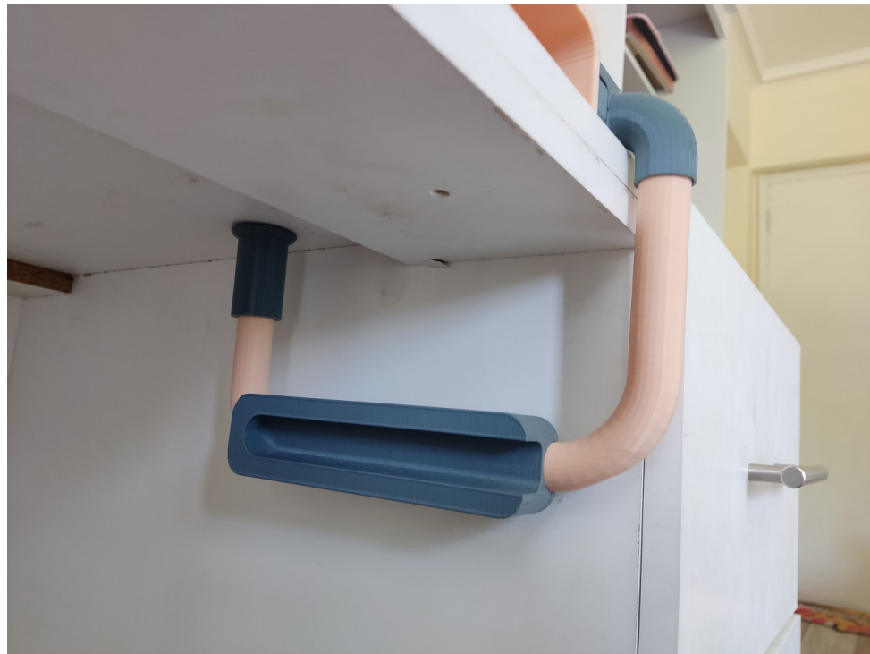
Figura 60. Anclaje inferior tubos de soporte. Elaboración propia.
