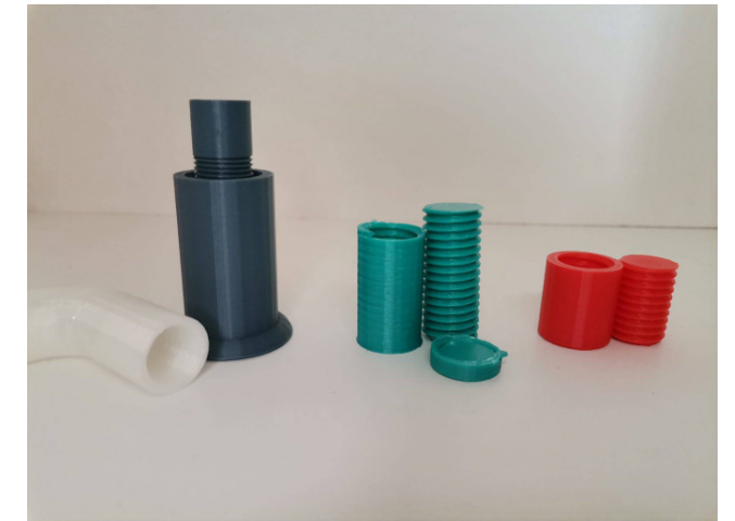
Figura 58. Prueba de calce rosca. Elaboración propia.
