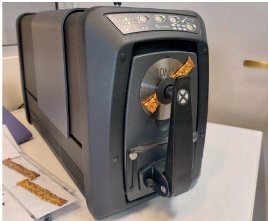
Fig 32. Espectrofotómetro de escritorio con el que se tomaron las medidas de los colores. Elaboración propia.
