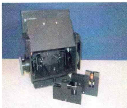
Figura 2.4 Accesorio Autoseagull montado sobre el banco óptico del Bruker Equinox 55, controlado automáticamente. Utilizado en registros de reflexión-absorción, RAIRS.
