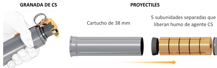
Figura 12. Diagrama de formatos de dispersión de gases lacrimógenos (extraído y modificado de Reuters, 2019).
