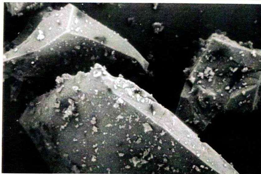
**Figura V.3.8.** Micrografía SEM de la fractura de una placa del compuesto  $[\text{Cp}(\text{dppe})\text{Fe}-\text{NCCH}_3]\text{PF}_6 \cdot \gamma\text{-CD}$
